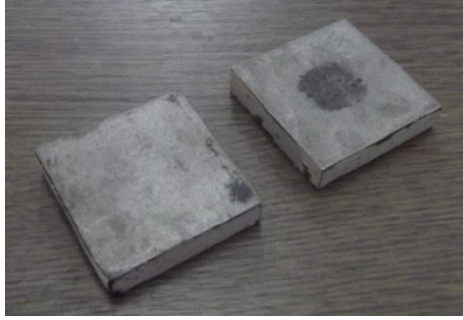
Şekil 6.14 Kırma başlıkları ( 4 \times 4 \times 1 ) cm 3 .
