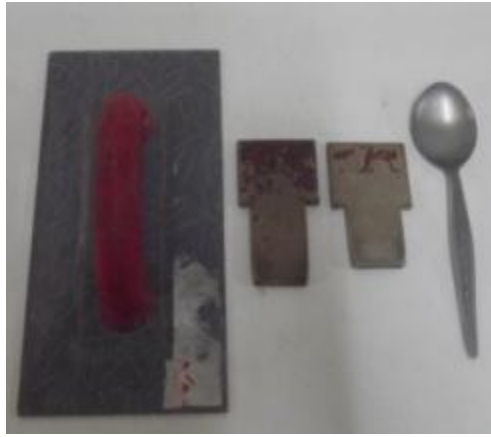
Şekil 6.11 Harç Düzleyici, Büyük, Küçük Yayıcılar ve Kaşık Aparatları.
