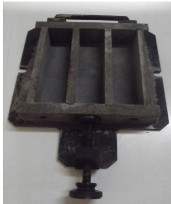
Şekil 6.9 Standart Beton Kalıbı.
