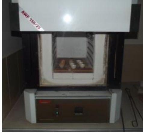
Şekil 6.5 Seramik Krozelerin Deney Öncesi Fırına Yerleştirilmesi.
