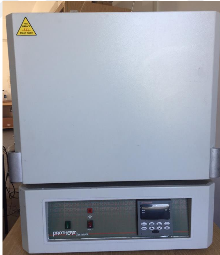
Şekil 3.3 PROTHERM (Model PTF 12/75/200) programlanabilir kül fırın
