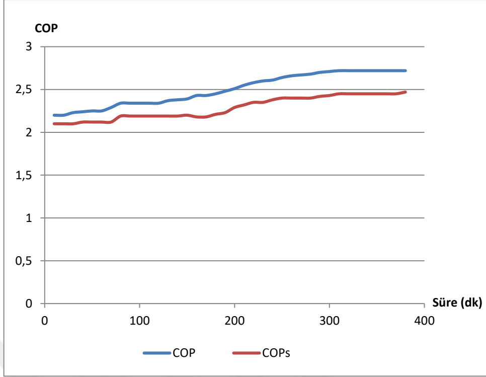
Şekil 4.14. Sütü soğutma modunda ısı pompası ve sistemin performans katsayısı değişimi
