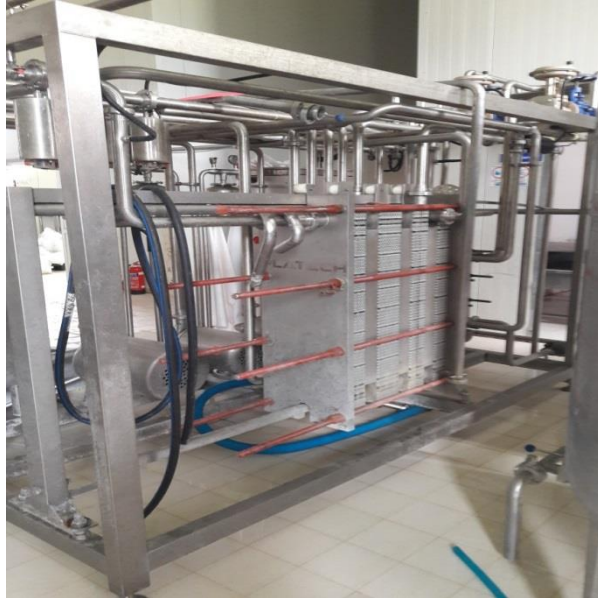
řekil 2.7. Plakalı pastörizatör makinası (İkizler Süt Fabrikası'ndan)
