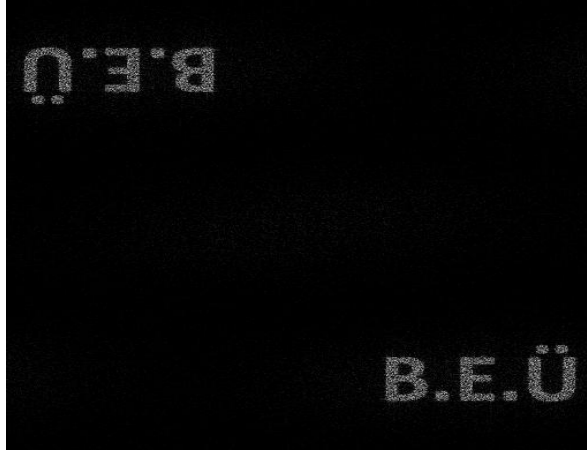
Şekil 4.4 FDA ile faz bilgisi bulunan tek hologramdan FKİ ile geri elde edilen cismin görüntüsü.
