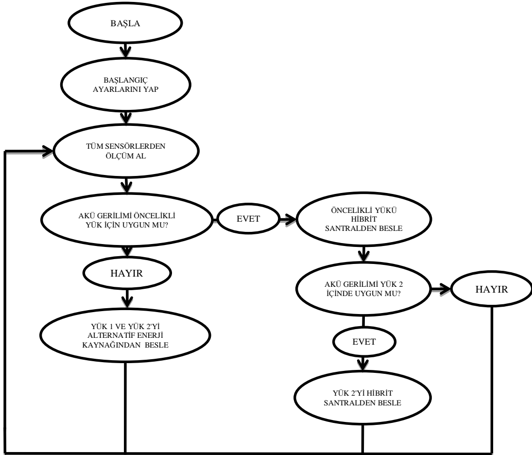
Şekil 6.3 Denetim sistemi kontrol akış şeması.
