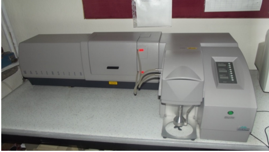
Şekil 5.3 Malvern Mastersizer S 2000 cihazına ait bir görünüm.
