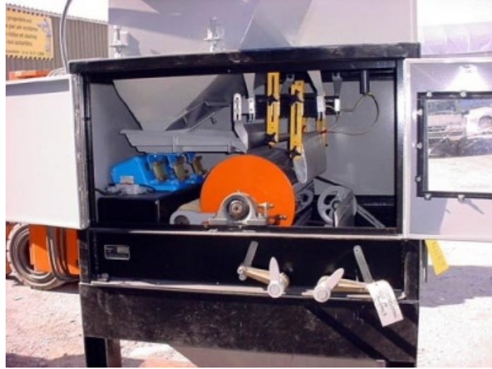
Şekil 4.17 Carpco Elektrostatik Ayırıcısı (Infomine, 2012).
