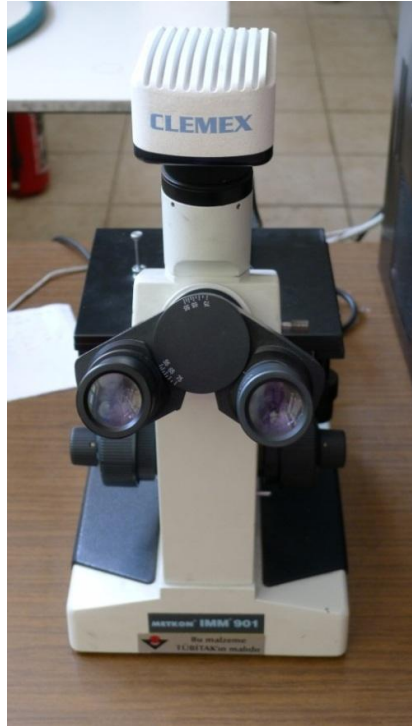
Şekil 6.3 Metkon IMM 901 marka optik mikroskop ve Clemex görüntü analiz cihazı.
