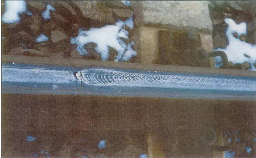
Şekil 5.4 Raylarda görülen yuvarlanma-kayma aşınması (URL-1 2013).
