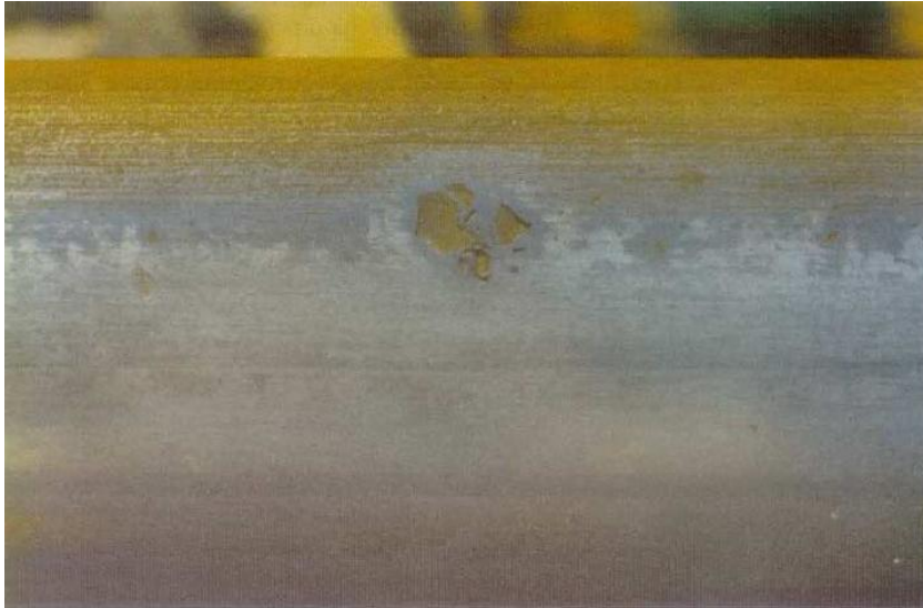
řekil 5.5 Ray abrasiv aşınma hasarı (URL-1 2013).
