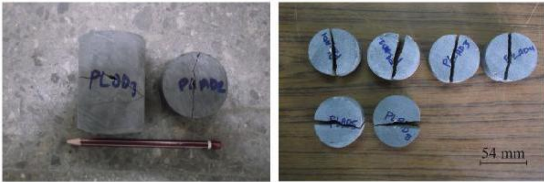
Şekil 6.37 Nokta yükü dayanım deneyi sonucunda kırılmış bazı numuneler (Kalemin boyu 130 mm'dir.).
