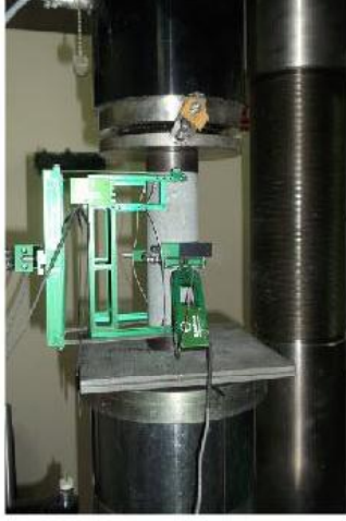
Silttaşı Numunesi (Üzülmez 2. Ocak Piriç Ayak) a) Deneyden Önce
