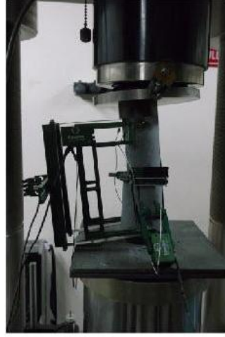
Silttaşı Numunesi (Üzülmez 2. Ocak Piriç Ayak) a) Deneyden Önce
