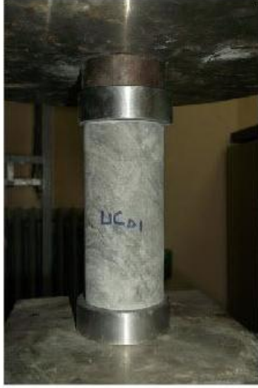
İnce Taneli Kumtaşı Numunesi (Üzülmez 1. Ocak Çay Ayak)
