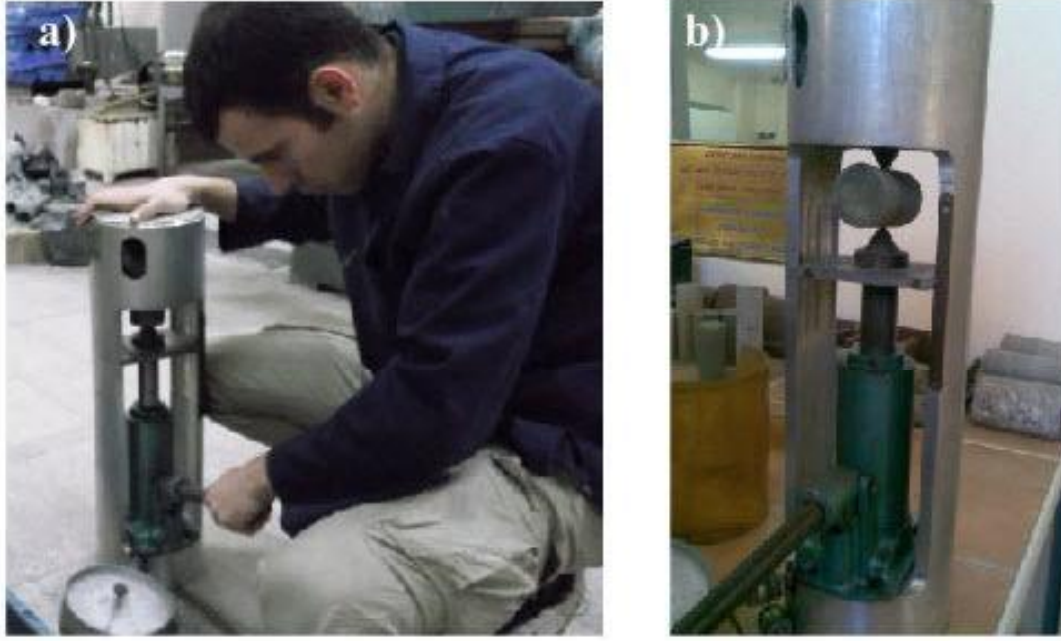
Şekil 6.36 Nokta yükü deneyi yükleme koşulları : a) Aksenal yükleme b) Çapsal yükleme.
