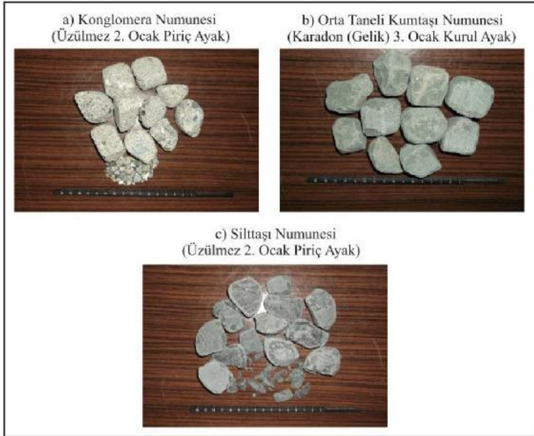
Şekil 6.43 Altıncı çevrim sonunda bazı tavan kayaçlarının durumu.
