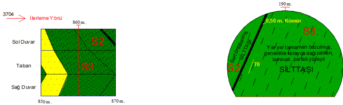
Şekil 5.17 3704 nolu galeride 860. metrede silttaşı ve kömürlü formasyondan alınan kesit.
