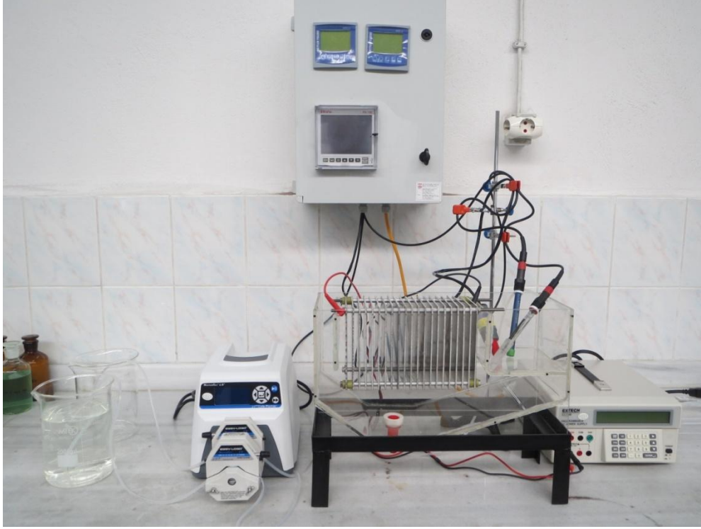
Şekil 4.5 Büyük hacimli elektrokoagülasyon deney düzeneği (V = 14 L).
