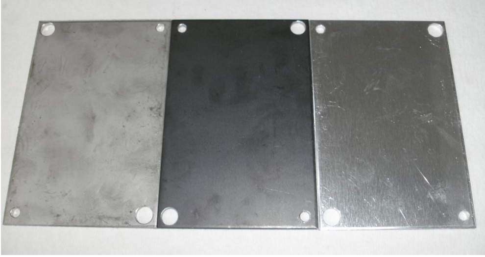
Şekil 4.7 Büyük ünite de kullanılan elektrotlar (soldan sağa; çelik, demir ve alüminyum).
