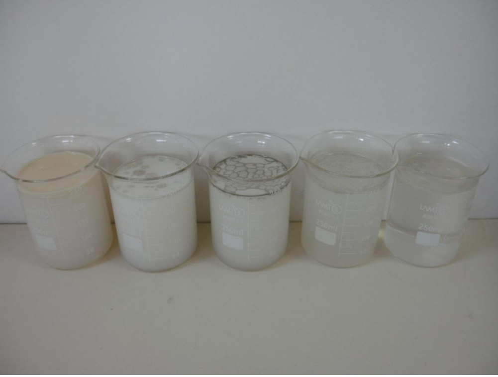
Şekil 5.26 Elektrot alanının elektrokoagülasyona etkisi (4 elektrot).
