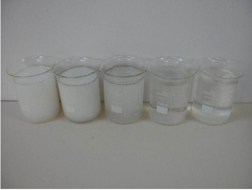
Şekil 5.28 Elektrot alanının elektrokoagülasyona etkisi (12 elektrot).
