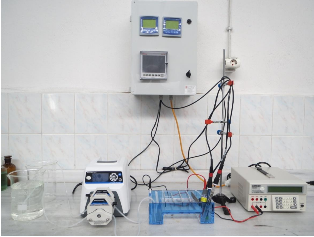
Şekil 4.4 Küçük hacimli elektrokoagülasyon deney düzeneği (V = 1.75 L).
