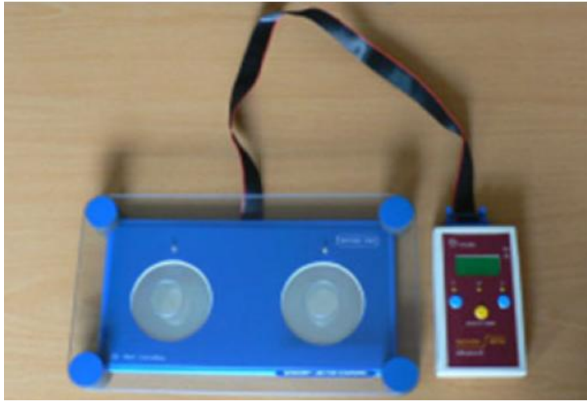
Şekil 1.3 Manyetik sensörlü dijital parmak vuru testi cihazı.
