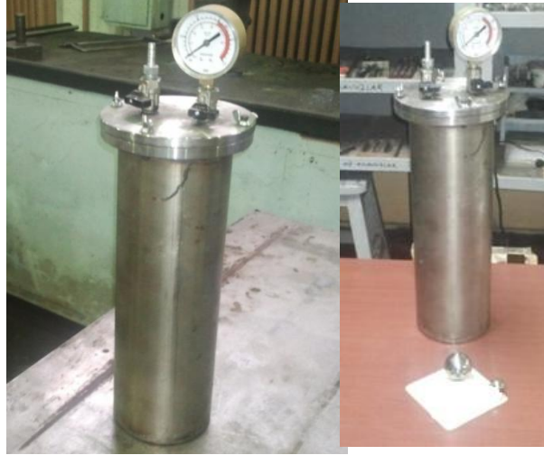
Şekil 5.2 Sızdırmaz kap ve kap içindeki bilya
