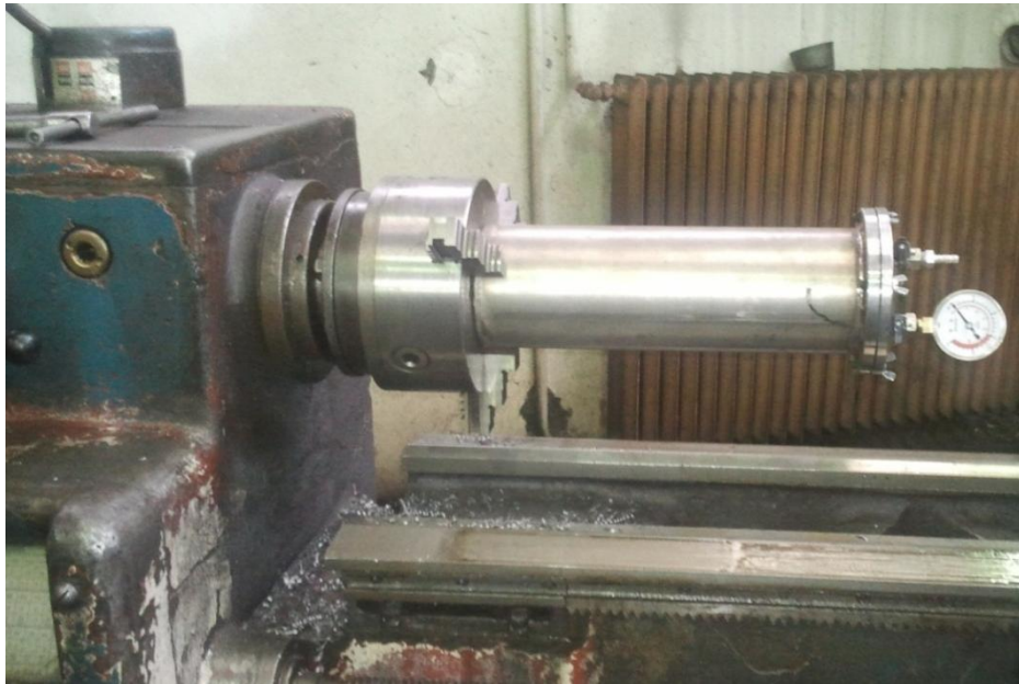
Şekil 5.5 Sızdırmaz kapların bağlandığı makine
