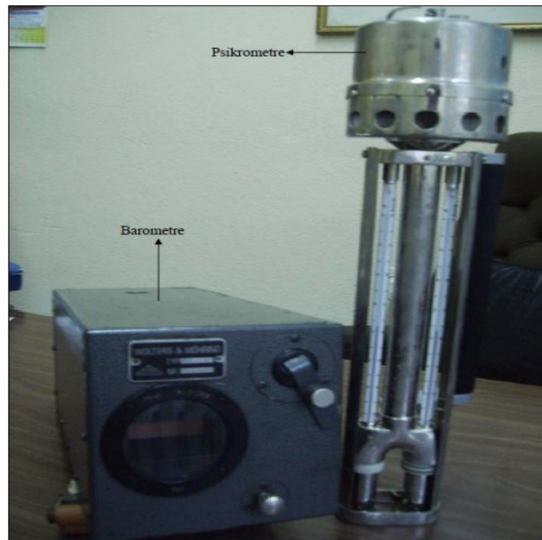
Şekil 5.3 Barometre ve psikrometre
