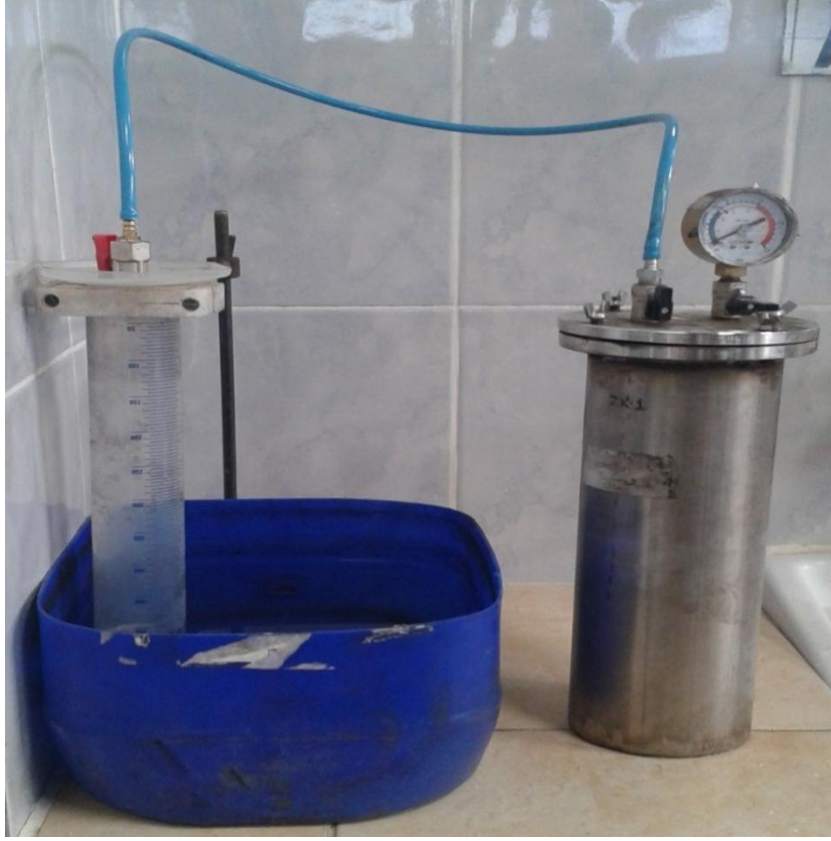
Şekil 5.4 Su dolu bir kap içeren ölçekli düzenek (dereceli kap)
