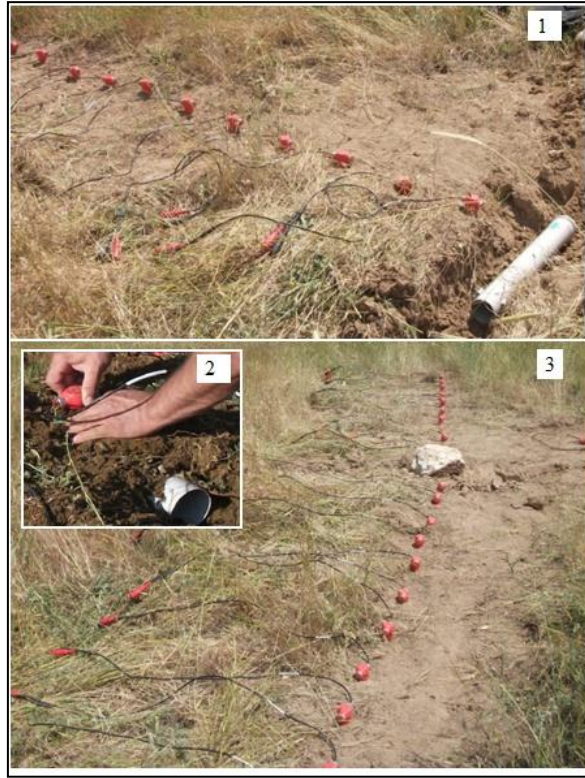
Şekil 2.5 Algılayıcıların yerleştirilmesi. 1) Deneyin yapıldığı plastik tünelin yerleştirilmesi, 2) 13 Numaralı algılayıcının plastik tünel üzerindeki konumu ve 3) 24 Algılayıcının tamamının görünümü (En son uçlardaki algılayıcılar arasındaki mesafe toplam olarak 17m).
