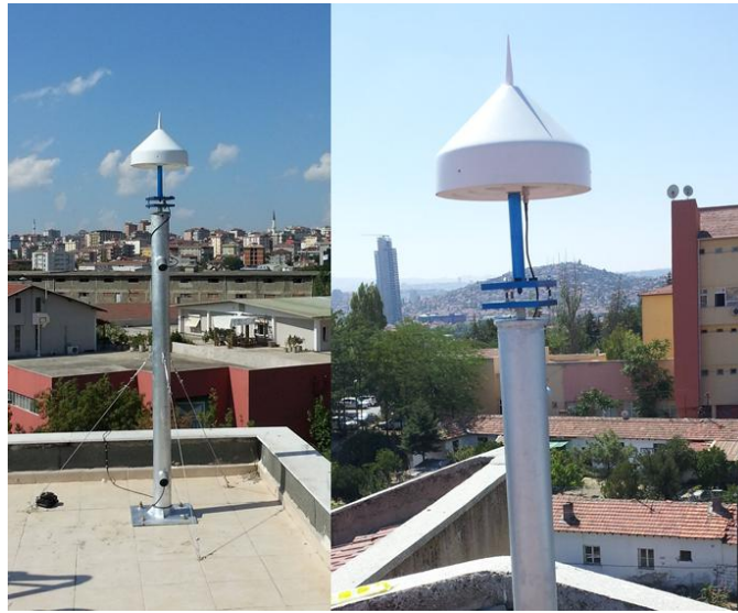
Şekil 3.1 Çalışma kapsamında kurulan GNSS alıcıları (Sol; GISM, Sağ; GANM)
