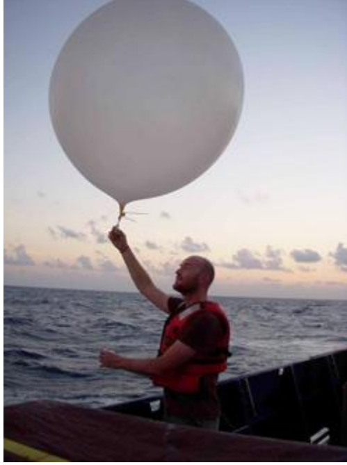
Şekil 2.4 Helyum gazı ile şişirilmiş radyosonda balonu.
