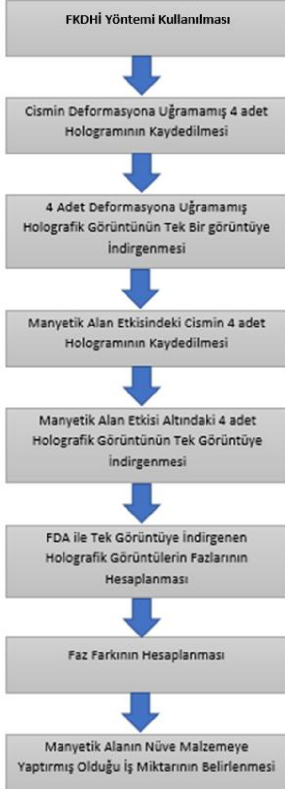
Şekil 5.2 FKDHİ yöntemi ile nüve malzemelerin yaptığı iş miktarının tespit edilmesinin akış şeması.
