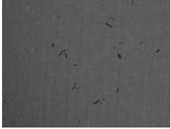
Şekil 5.29 Manyetik alan etkisine maruz bırakılan M5 nüve örneğinin dijital hologramı.
