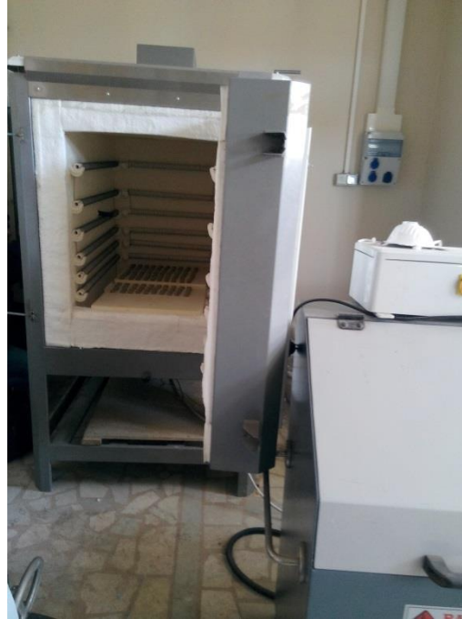
Şekil 4.4 1200 °C pişirme kapasiteli laboratuvar tipi elektrikli fırın.
