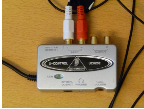
Şekil 5.1 İnce düzlemlerde ultrasonik dalga yayılımının modellenmesi için yapılan deneylerde kullanılan veri aktarım cihazı.
