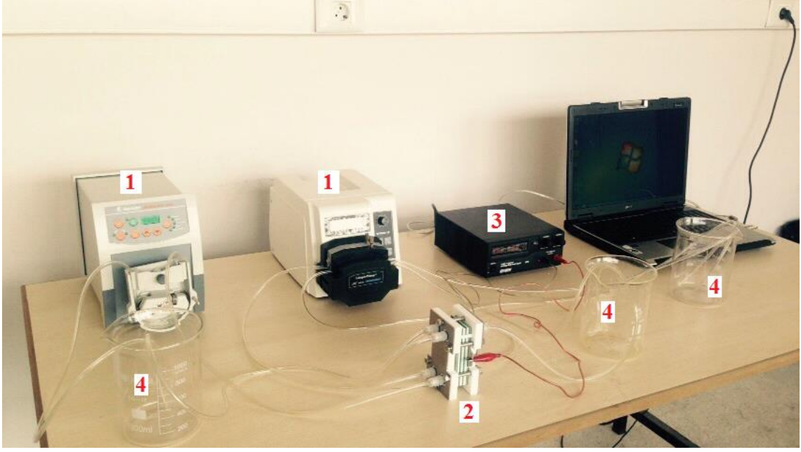
Şekil 5.1 Deneysel çalışmada kullanılan elektrodializ sistemi (1- Peristaltik Pompa, 2- Elektrodializ modülü, 3- Güç Kaynağı, 4- Rezervuarlar)
