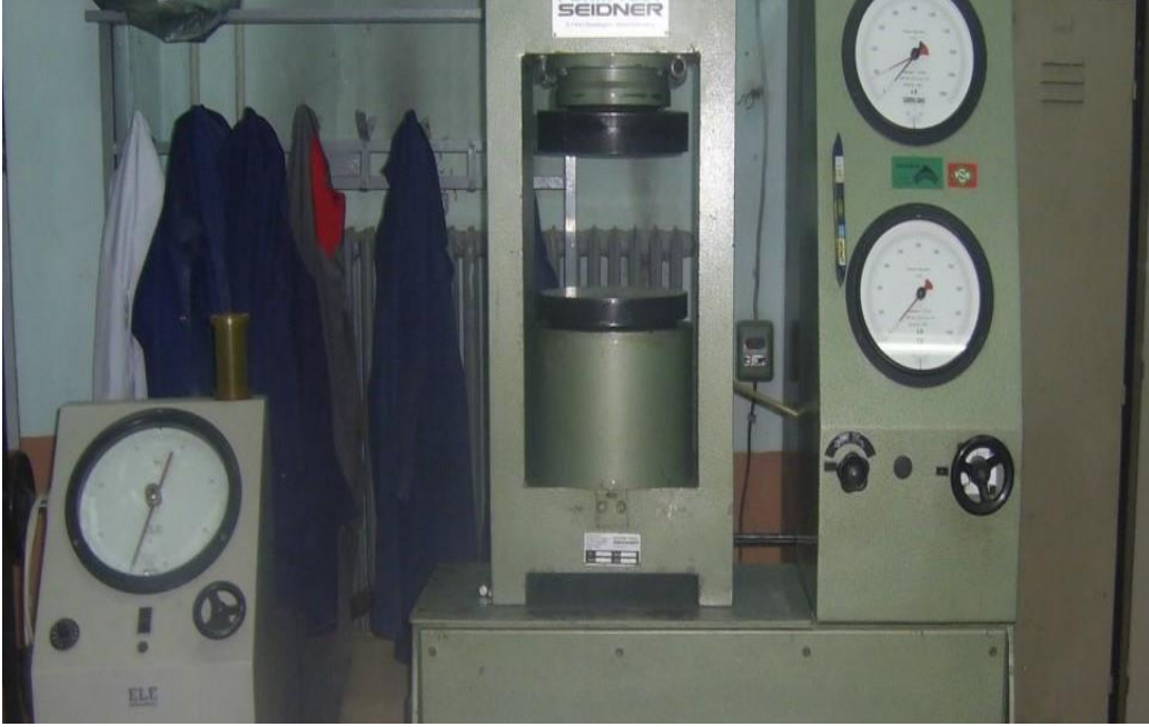
Şekil 4.4 Tek eksenli basınç ve dolaylı çekme dayanımı deneyinde kullanılan pres.
