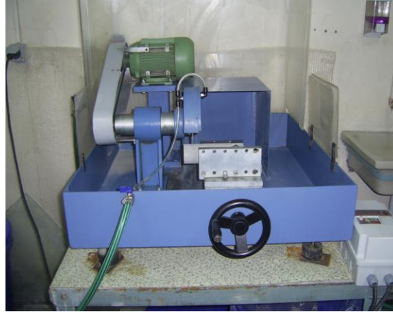
Şekil 4.2 Taş kesme makinası.
