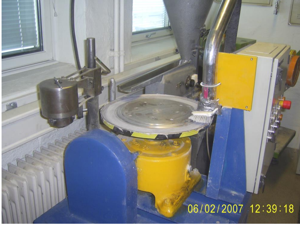
Şekil 4.19 Norveç SINTEF'deki orijinal Norveç aşınma deney aleti.
