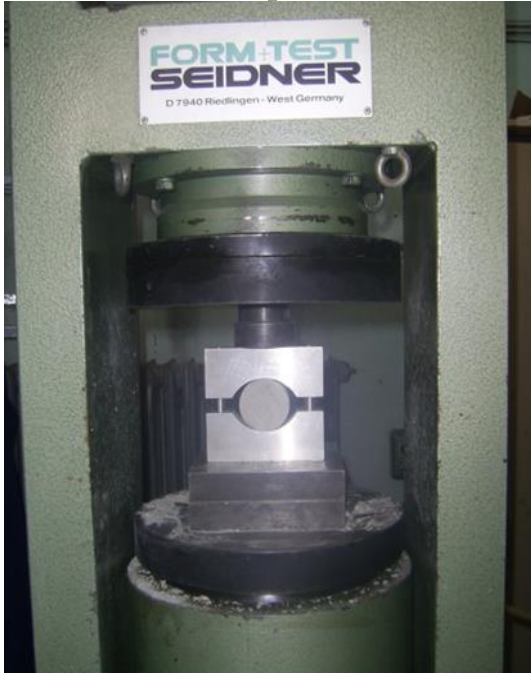
Şekil 4.6 Dolaylı çekme deney aleti.
