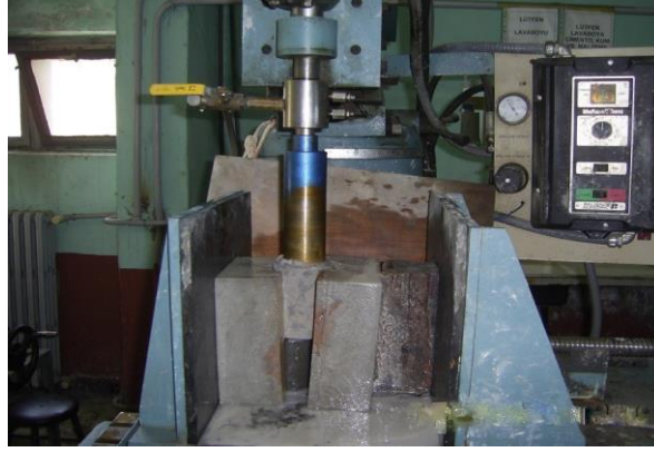
Şekil 4.1 Karot alma makinası.
