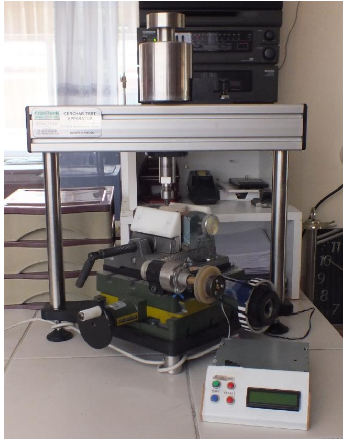
Şekil 4.14 West tam otomatik Cerchar aşınma indeksi deney aleti.
