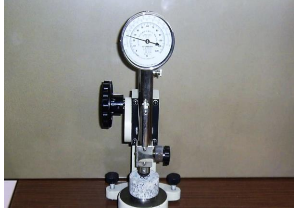
Şekil 4.8 Shore skleroskopu deney aleti.
