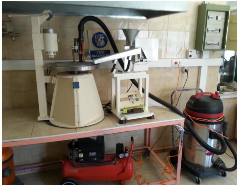
Şekil 4.18 Norveç aşınma deney düzeneği.
