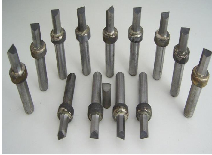
Şekil 4.11 SJ deneyinde kullanılan özel uçların geometrisi ve hazırlanmış uçlar.
