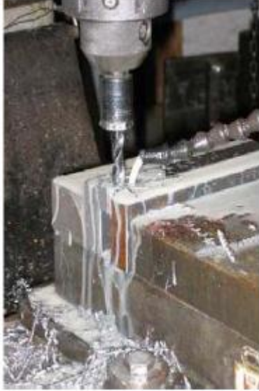
Şekil 3.1 Metal kesme esnasında kesme sıvılarının kullanımı (Aşkın 2011).
