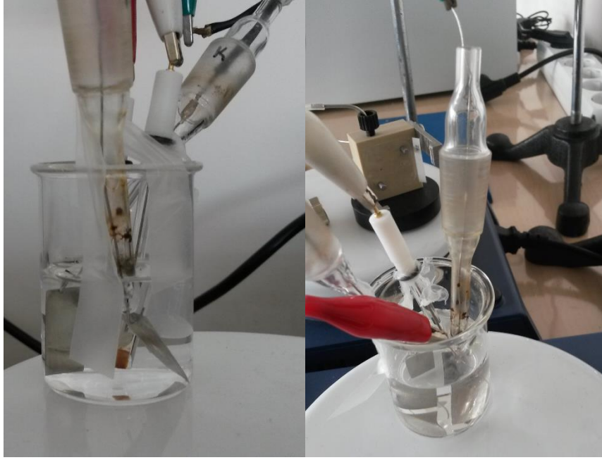
Şekil 6.15 Elektrokimyasal hücre sistemi (glikoz oksidaz kaplı elektrot, laktaz kaplı elektrot, karşıt elektrot (platin tel), referans elektrot (Ag/Ag/Cl)).
