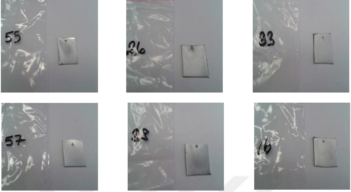
Şekil 3.8 Krom kaplanmış numunelerden bazı örnek fotoğraflar.
