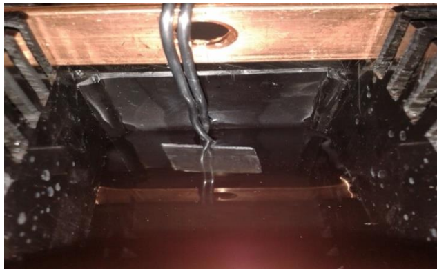
Şekil 3.3 Anotun banyo çözeltilisine daldırıldığı andaki görüntüsü.
