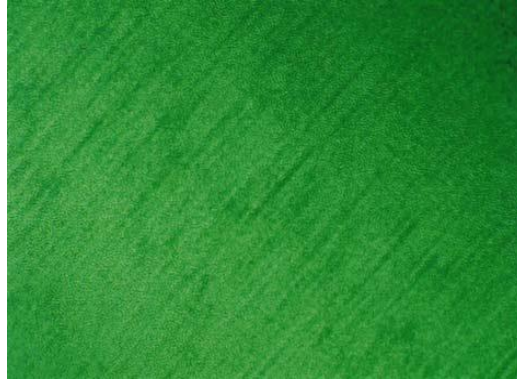
Şekil 2.16 Katalizör ilave edilmiş mikro çatlaklı krom kaplı yüzey (100 büyütme) [5].
