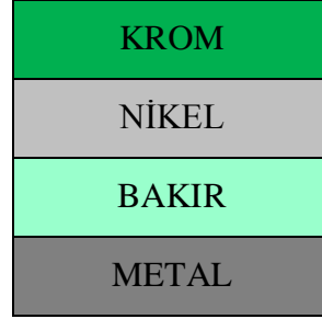
Şekil 2.5 Dekoratif krom kaplama için işlem adımları.
