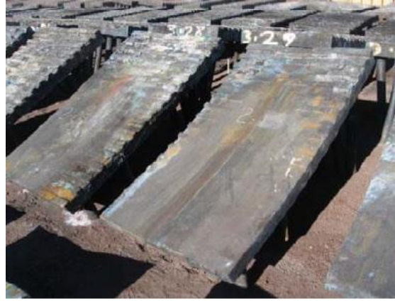
Şekil 1.15 Mekanik abrazyona uğramış panel soğutucu (Laar and Engel 2015).
