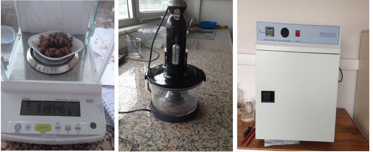
Şekil 7.3 Deneylerde kullanılan hassas terazi, bıçaklı doğrayıcı ve fanlı etüv.
