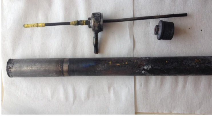
Şekil 7.9 Numunenin yerleştirildiği çelik reaktör.
