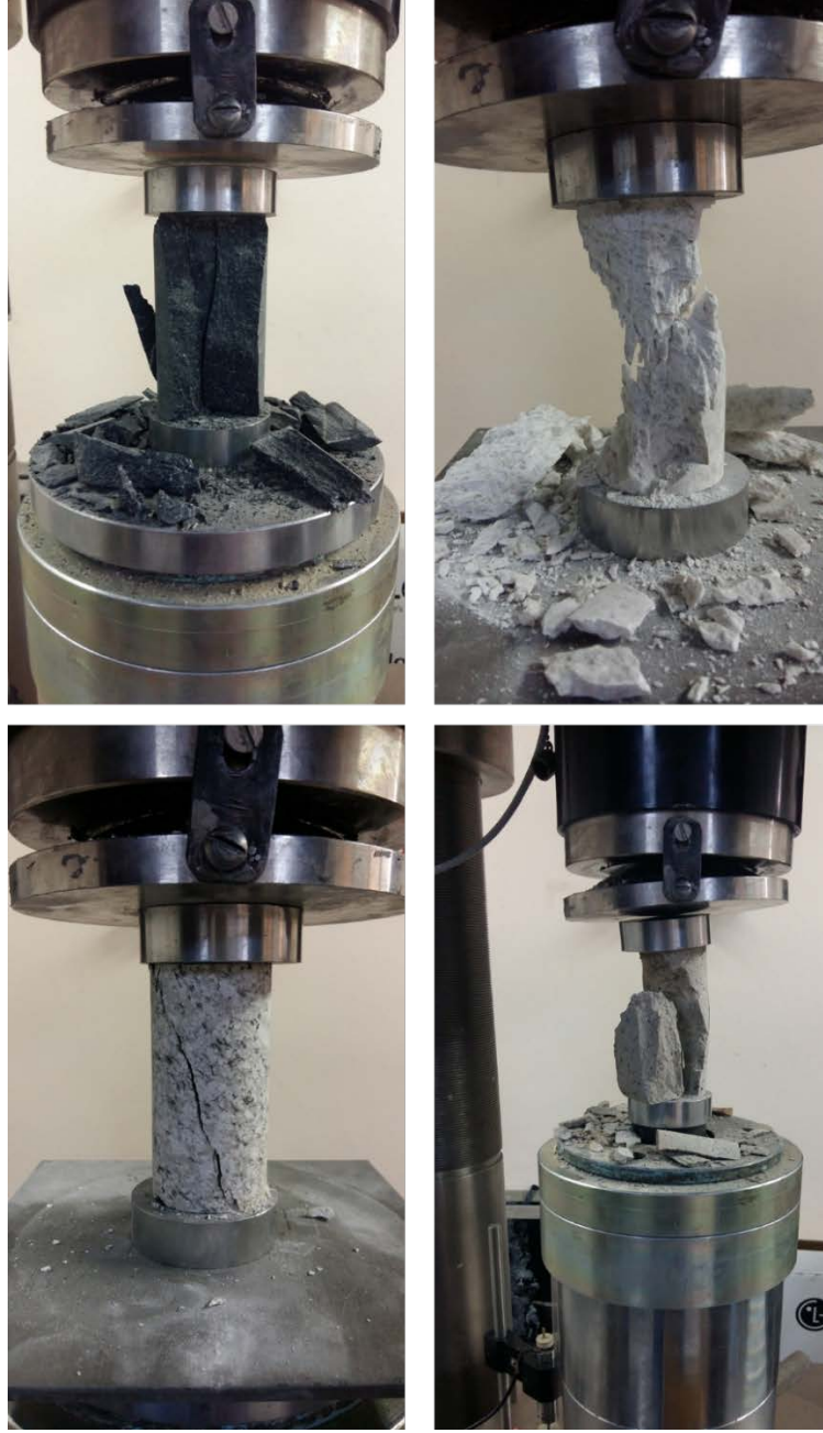
Şekil 4.17 Tek eksenli basınç dayanımı deney sonucunda farklı kayalarda gözlenen yenilme tipleri.
