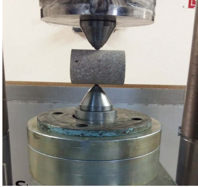
Şekil 4.3 Laboratuvar ortamında yapılan çapsal nokta yükü deneyi.
