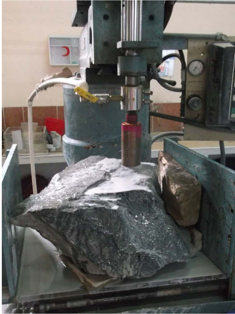
Şekil 3.1 Karot alma makinesi ile karot örneklerinin alınması.
