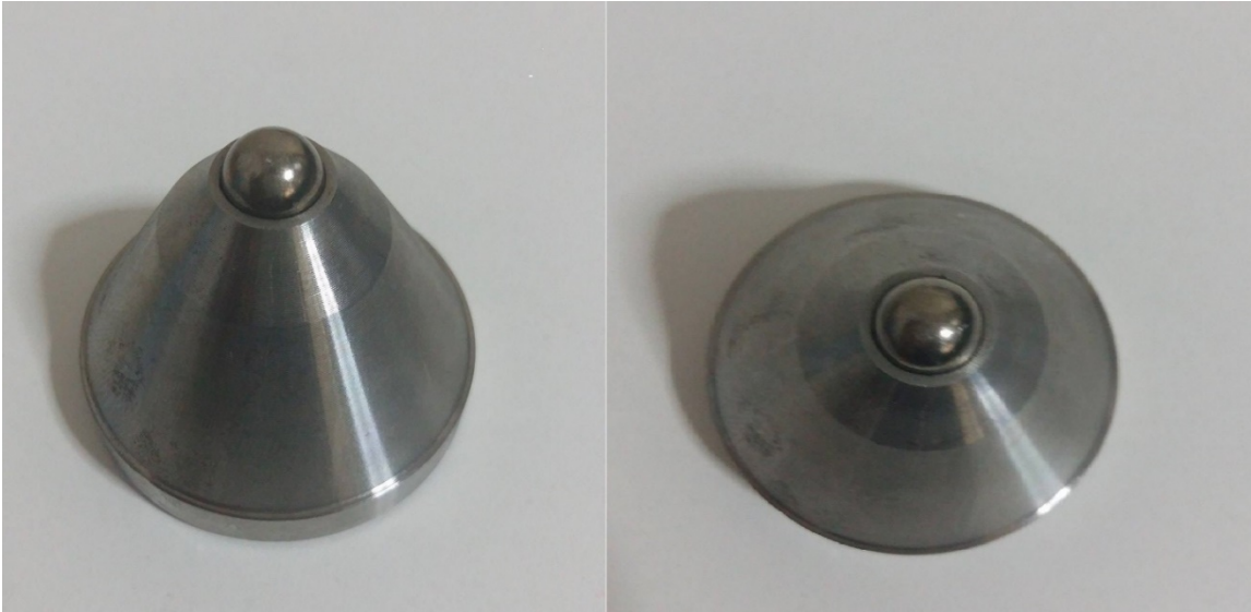
Şekil 4.7 TTK Merkez Atölyesinde nokta yükü dayanım indeksi için hazırlanan yükleme başlıkları.
