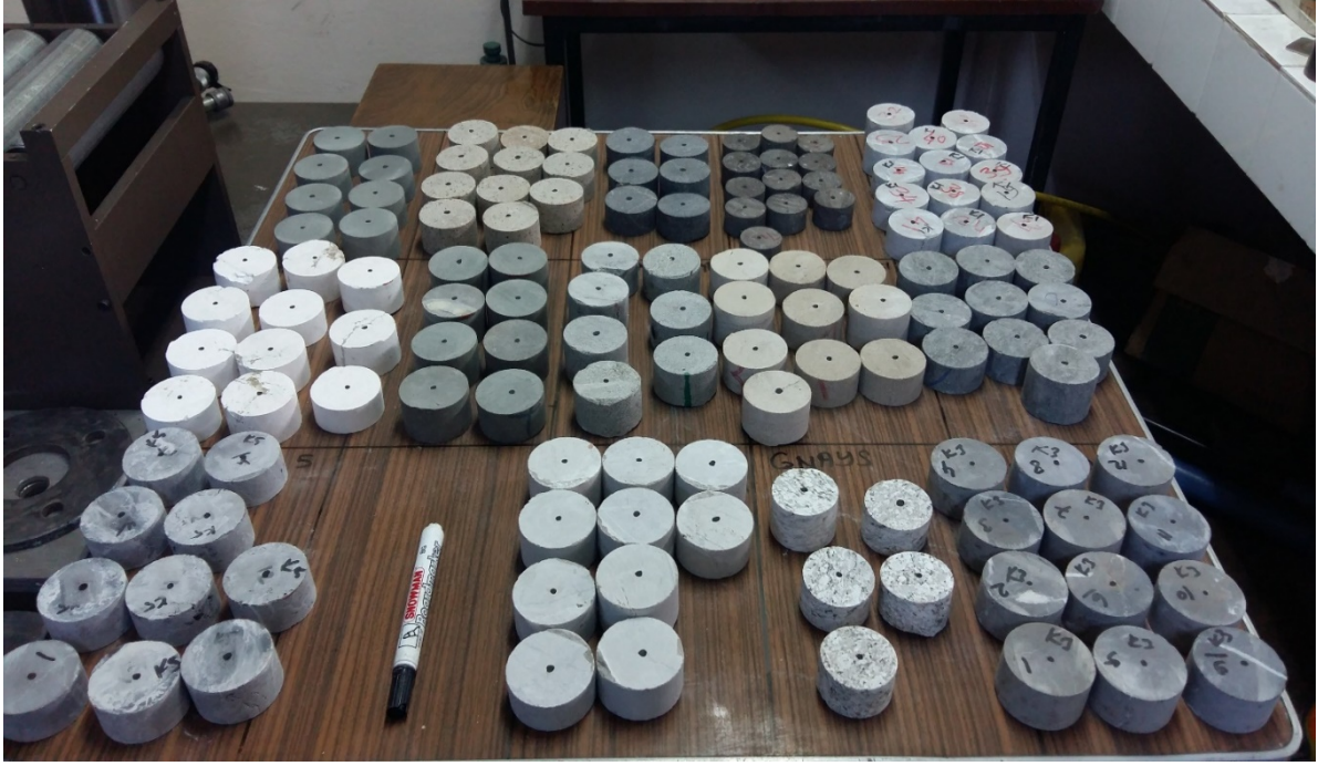
Şekil 4.6 Tez kapsamında kullanılan aksel nokta yükü dayanım indeksi deney örnekleri.
