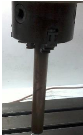
Şekil 3.3 Numunelerin işlenmesinde kullanılan bakır elektrot
