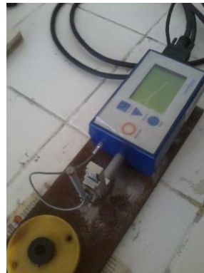
Şekil 3.6 Tylor Hobson yüzey pürüzlülük cihazı
