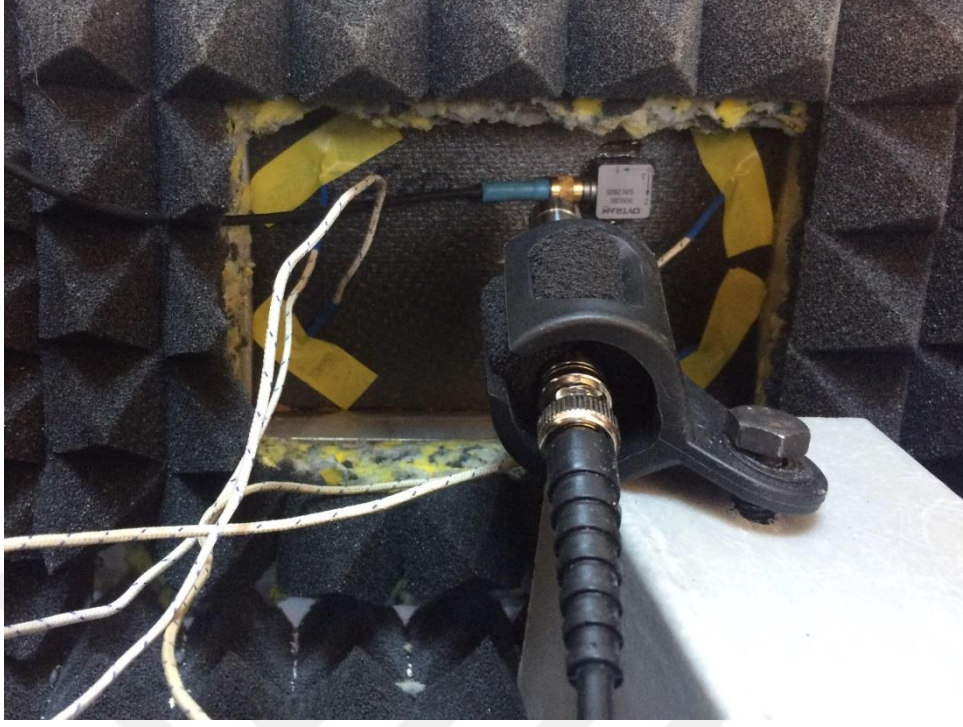
Şekil 4.8 Veri toplanan bölmedeki ivme ölçer ve termokaplar yapıştırılmış numune.
