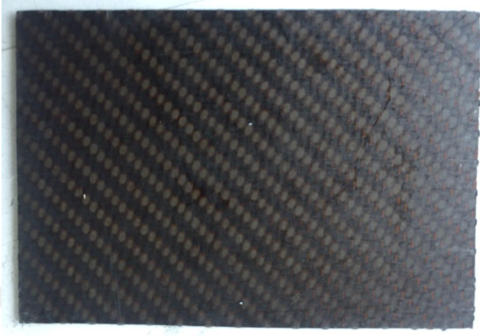
Şekil: 4.11 1.5 mm kalınlığında örgülü kompozit plaka.
