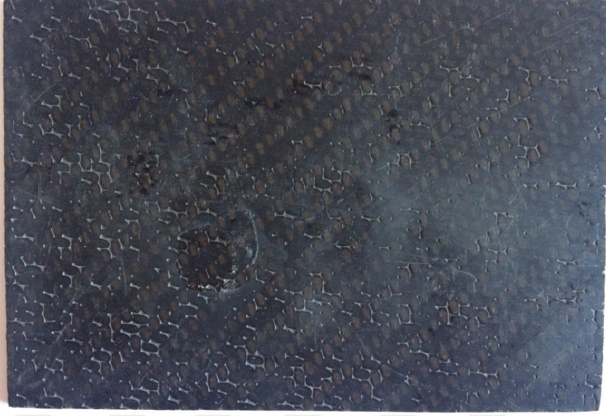
Şekil 4.17 1.5 mm kalınlıkta 1.84 J enerji ile hasara uğratılmış plaka.
