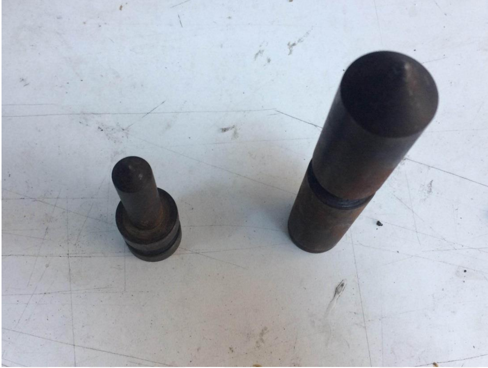
Şekil 4.14 45° tepe açısına sahip 150 g ve 500 g'lık kurşunlar.
