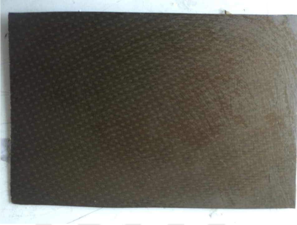
Şekil 4.9 0.5 mm kalınlığında örgülü kompozit plaka.
