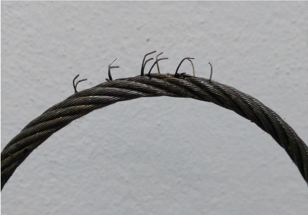
Şekil 5.12 Tel kırıkları verilmiş halat numunesi
