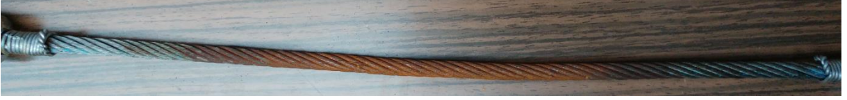
Şekil 5.15 Korozyona uğramış halat numunesi
