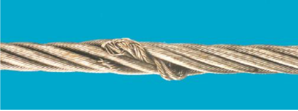
Şekil 4.8 Öz veya damarın dışarı çıkması [14]
