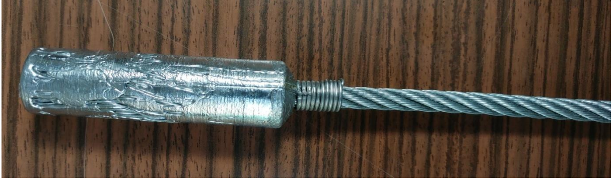
Şekil 5.10 İki ucuna beyaz metalden bir baş hazırlanmış halat numunesi
