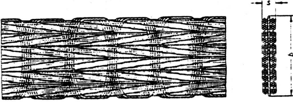
Şekil 2.13 Çift dikişli yassı halat, DIN 21256
