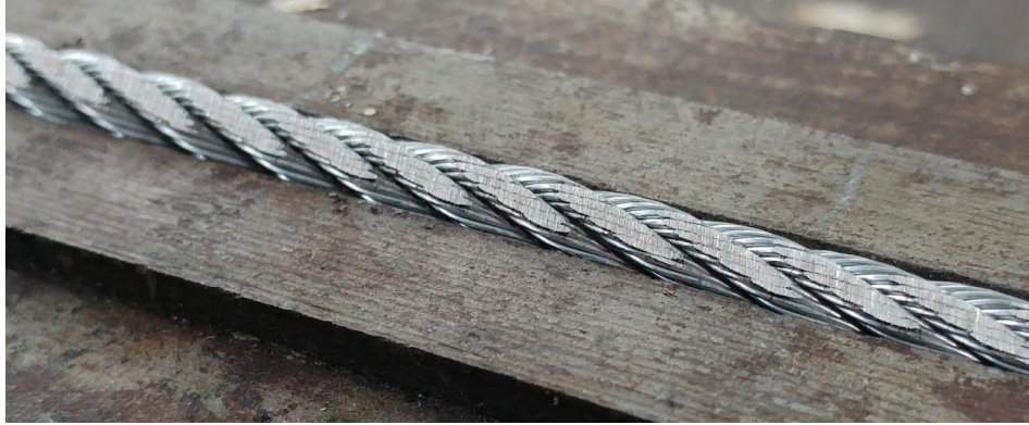
Şekil 5.13 Aşınmış halat numunesi
