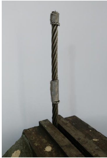
Şekil 5.5 Tellerine ayırma işlemine hazır numune
