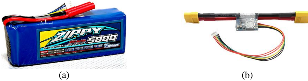
Şekil 4.9 Batarya ve güç modülü a) 4 hücreli batarya b) 3A BEC güç modülü.
