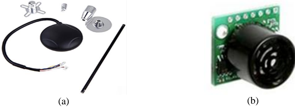
Şekil 4.7 GPS ve sonar modülleri. a) Ublox 6M GPS, b) Sonar (MBI030).
