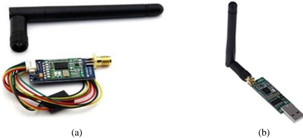
Şekil 4.3 Telemetri modülü. a) Telemetri verici, b) Telemetri alıcı.
