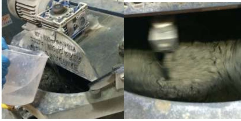
Şekil 3.34 Şahit katkısız numune için kıvam ayarı yapılması
