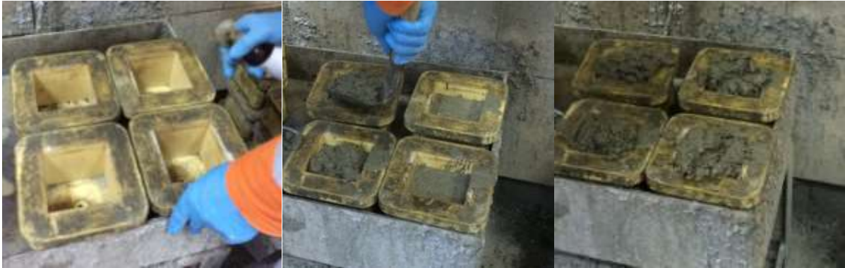
Şekil 3.31 150x150x150mm'lik kalıplara numune alımı
