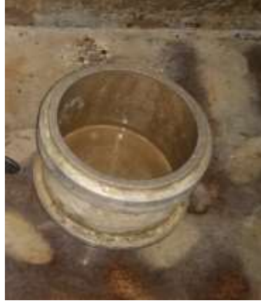
Şekil 3.28 Hacmi ve ağırlığı bilinen özgül ağırlık ölçüm kabı
