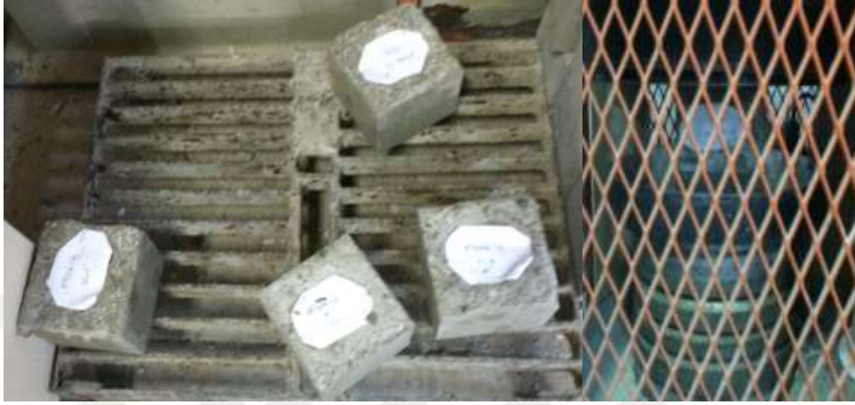
Şekil 3.32 Kür süresi dolmuş numunelerin basınç dayanımları ölçümü
