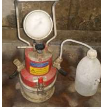
Şekil 3.30 Taze betonda hava miktarı ölçüm cihazı
