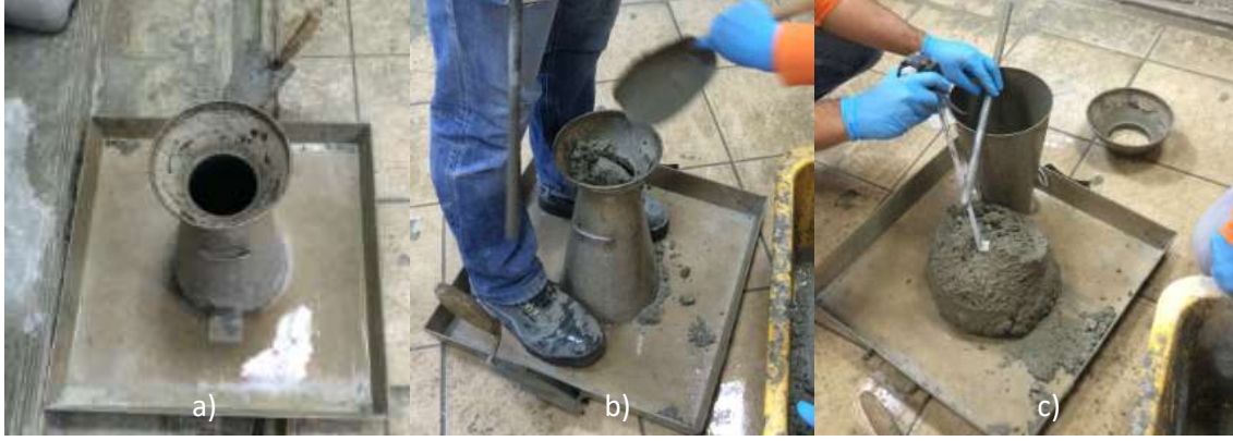
Şekil 3.27 Çökme testi a) hazırlanmış test düzeneği b) taze beton test aparatına üç eşit parça halinde doldurulur ve her doldurmada 25 kez şişlenir c) test aparatı yukarı doğru çekilir, üzerine şiş paralel bir şekilde yerleştirilerek beton ile şiş arasındaki yükseklik ölçülerek kayıt edilir. Ölçülen bu değer betonun çökme değeridir.
