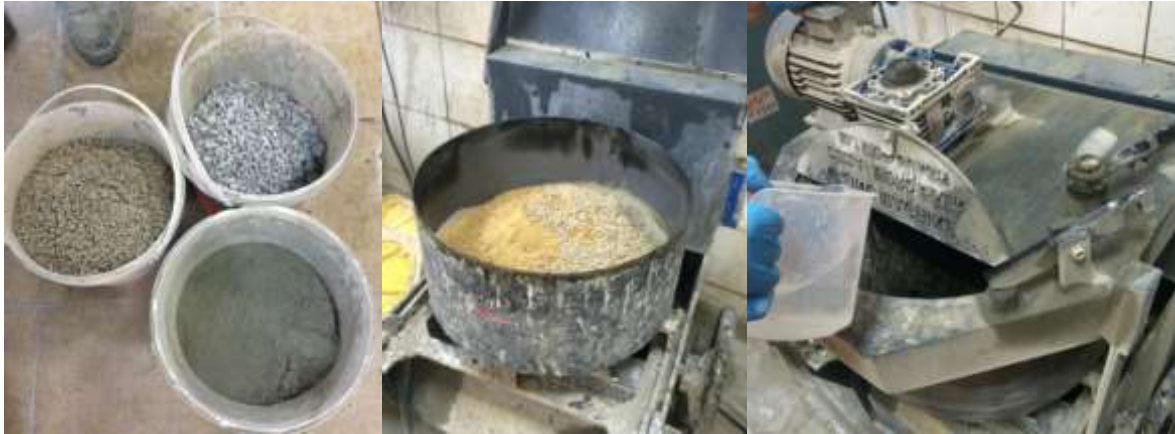
Şekil 3.33 Farklı granülometriye sahip agregalar ayrı ayrı tartılarak pan mikser içerisinde homojen bir şekilde karıştırılması
