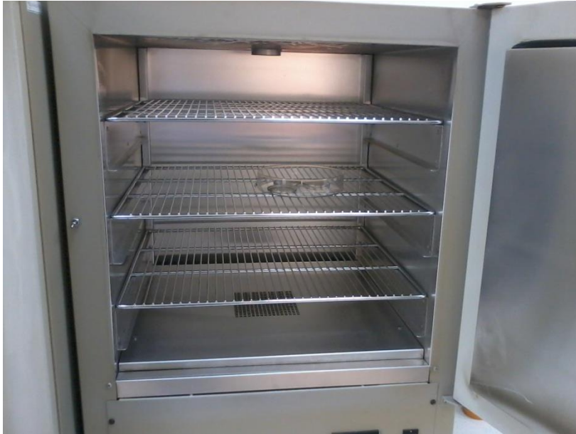
Şekil 4.6 Sabit tartım elde edinceye kadar kurutma işleminin tamamlandığı etüv.
