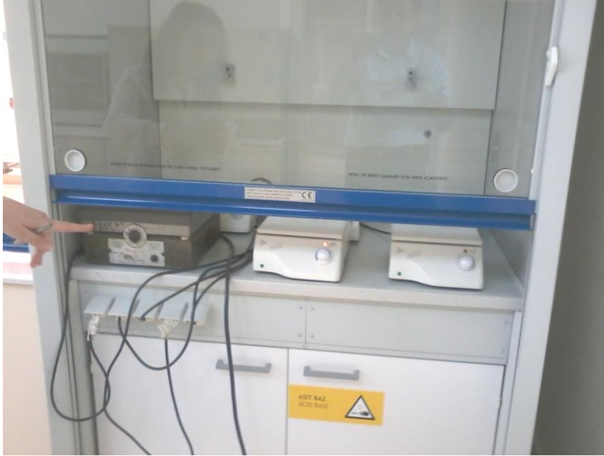
Şekil 4.4 Suyun kalıntısını elde etmek için öncelikle su numunesinin bir behere konulup ısıtılmasını sağlayan buharlaştırma sistemi.
