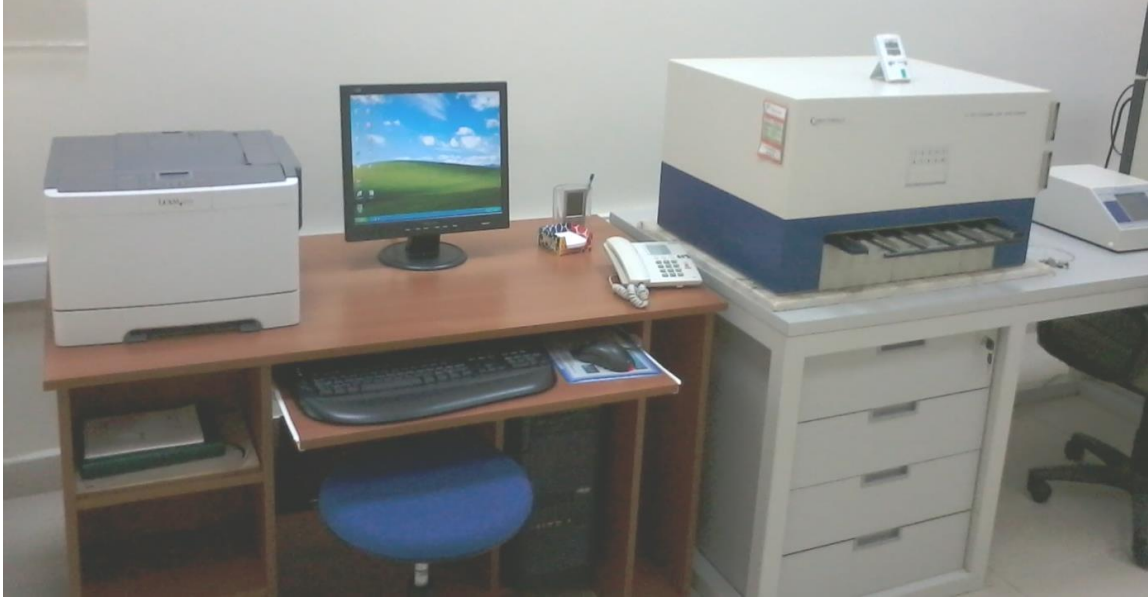
Şekil 4.7 Düşük ortam saymalı toplam alfa ve toplam beta sayma sistemi.
