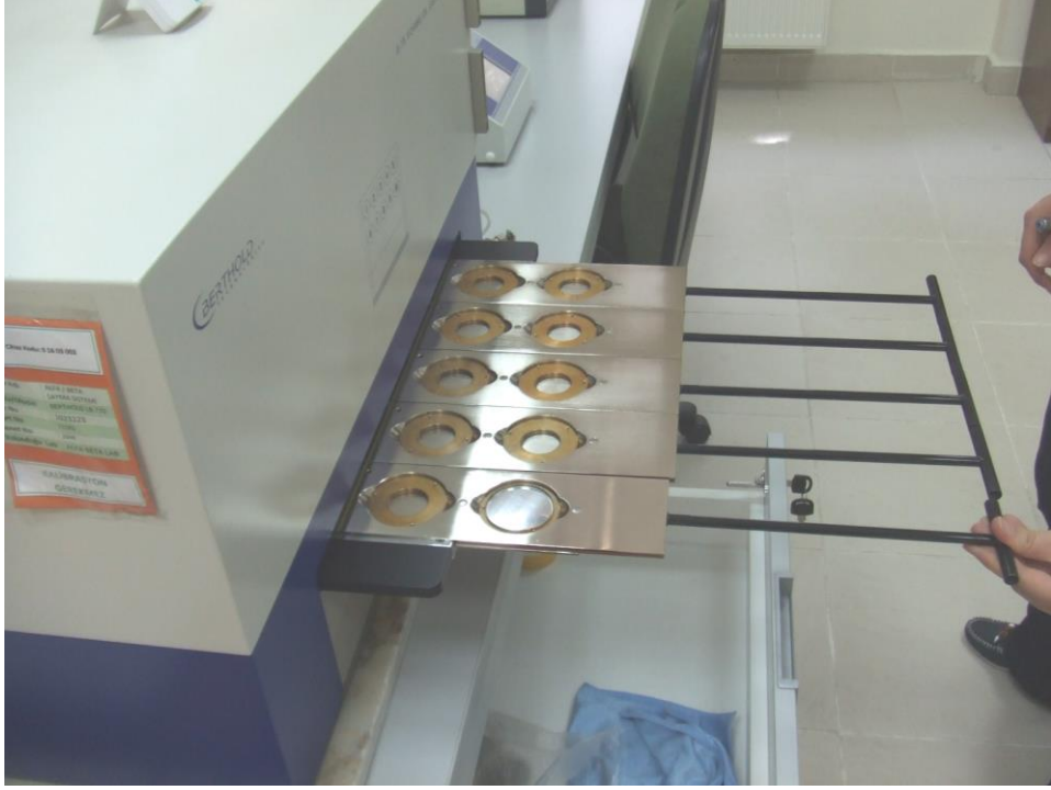
Şekil 4.2 Düşük ortam saymalı gaz akışlı orantılı alfa ve beta sayma aygıtı.
