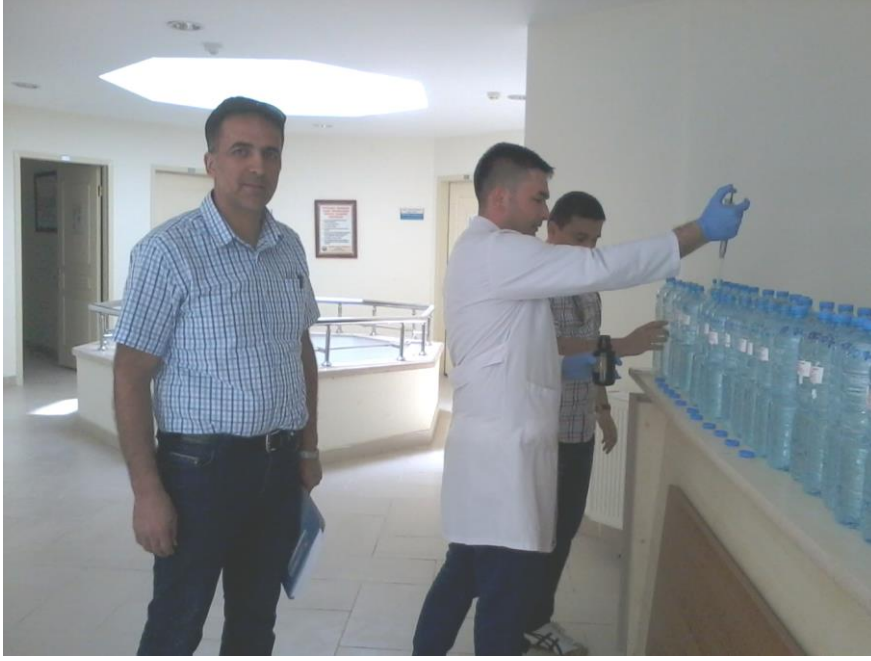
Şekil 4.3 Ölçümden önce, örnekleri korumak için örneklere pH değerleri 2 olacak şekilde 1 N HNO 3 asit ilave edilmesi.
