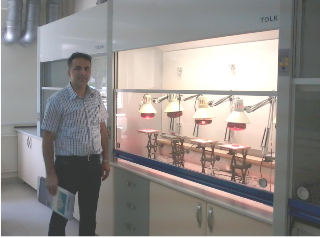
Şekil 4.5 İnfrared lamba altında çelik planşetlere aktararak yapılan buharlaştırma işlemi.
