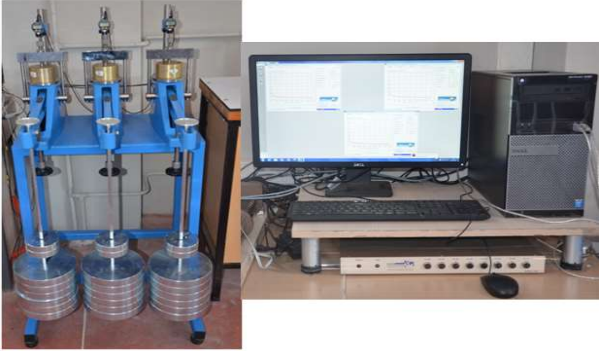
Şekil 3.1 BEU İnşaat Mühendisliği Araştırma Laboratuvarındaki konsolidasyon deney seti
