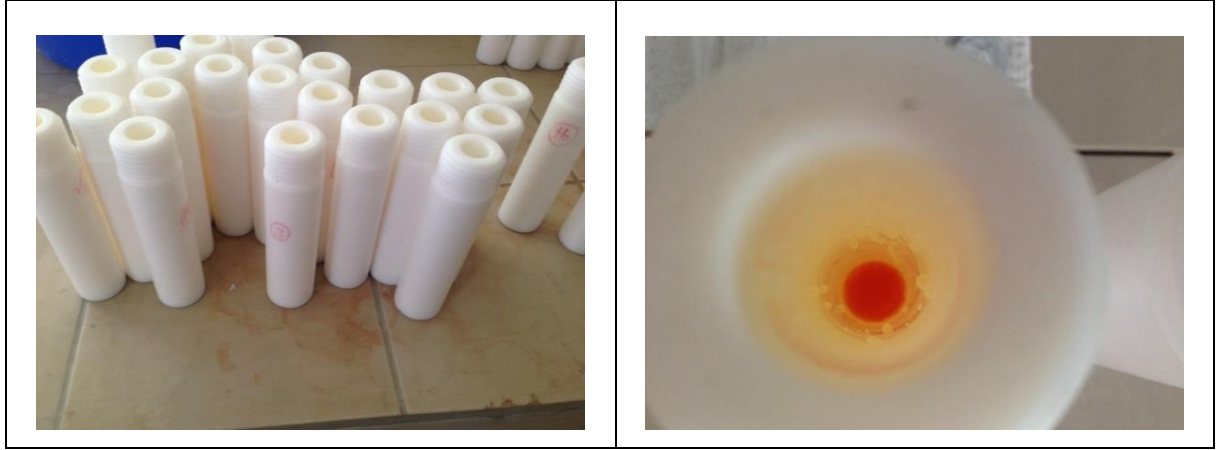
Şekil 3.7 Kullanılan mikrodalga kapları ve kimyasal ilavesiyle gerçekleşen reaksiyon
