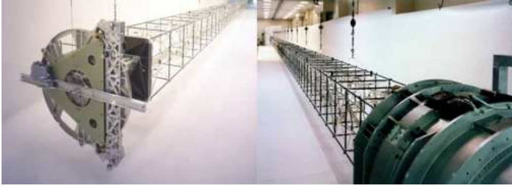
Şekil 2.33 60 m uzunluğundaki SRTM alıcı direği (NASA)
