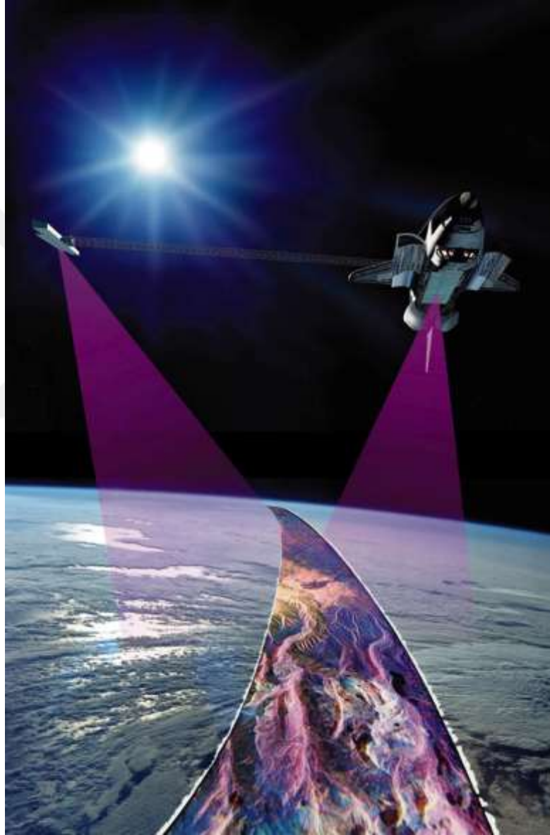
Şekil 2.30 Endeavour uzay mekiği ve SRTM çalışma prensibi (URL-9)
