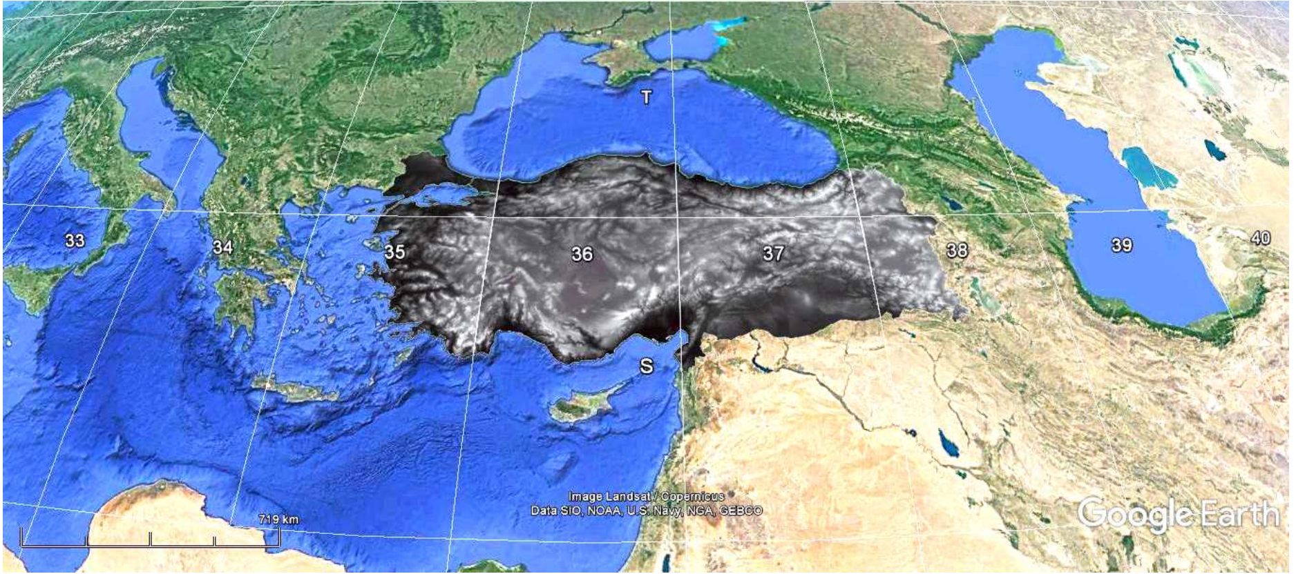
Şekil 5.17 Elde edilen dijital yüzey modelinin Google Earth programına aktarılması (SRTM C-band, UTM 6°, WGS84)
