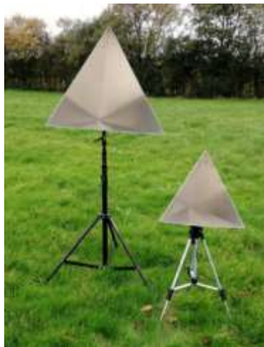
Şekil 2.26 Radargrametride kullanılan köşe yansıtıcıları (URL -8)
