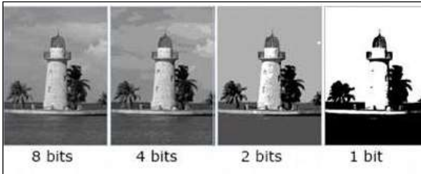
Şekil 2.7 Bit sayısına göre radyometrik çözünürlüğün gösterimi (URL-4)
