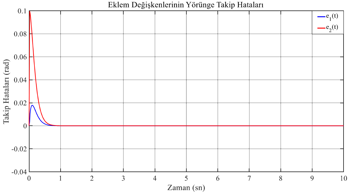
Şekil 5.5 PID denetimli RR eklem yapısına sahip yalpanın eklem değişkenlerinin e_1(t) ve e_2(t) yörünge takip hataları ( \omega_n = 20 ).
