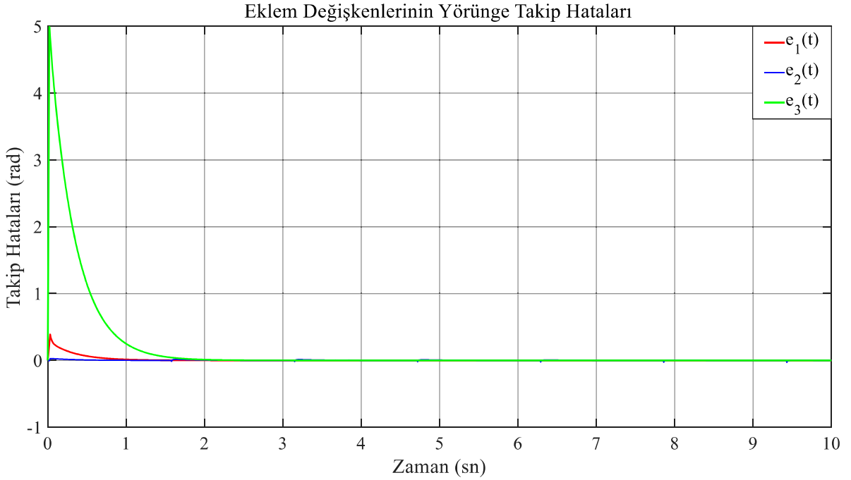
Şekil 5.14 PID denetimli RPR eklem yapısına sahip yalpanın eklem değişkenlerinin e_1(t) , e_2(t) ve e_3(t) yörünge takip hataları ( \omega_n = 20 ).
