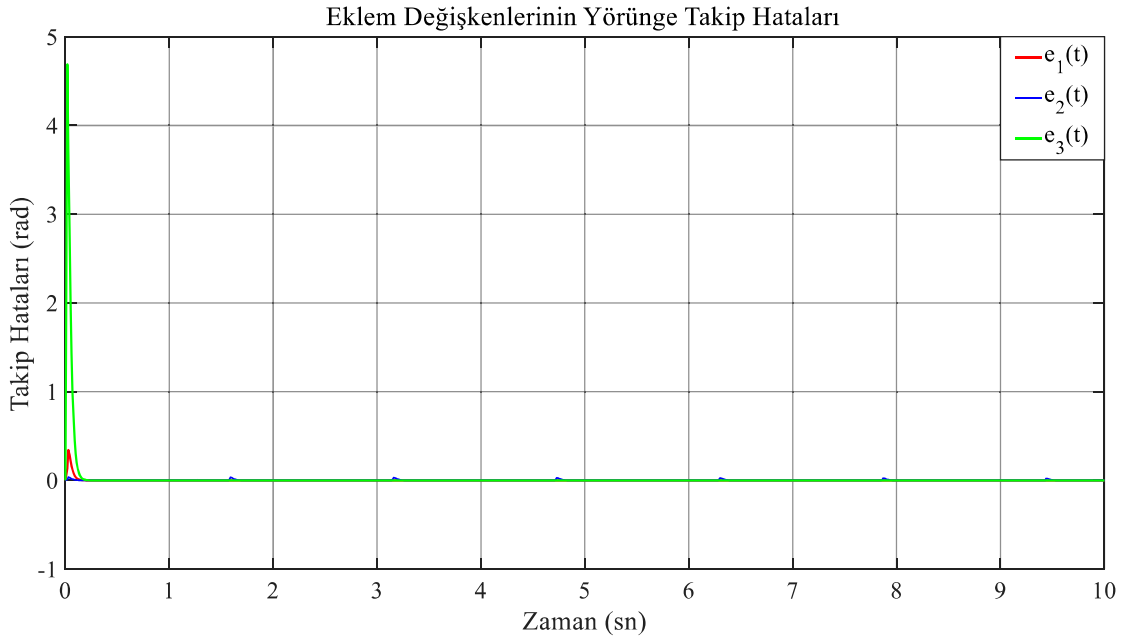
Şekil 5.10 PID denetimli RRR eklem yapısına sahip yalpanın eklem değişkenlerinin e_1(t) , e_2(t) ve e_3(t) yörünge takip hataları ( \omega_n = 20 ).
