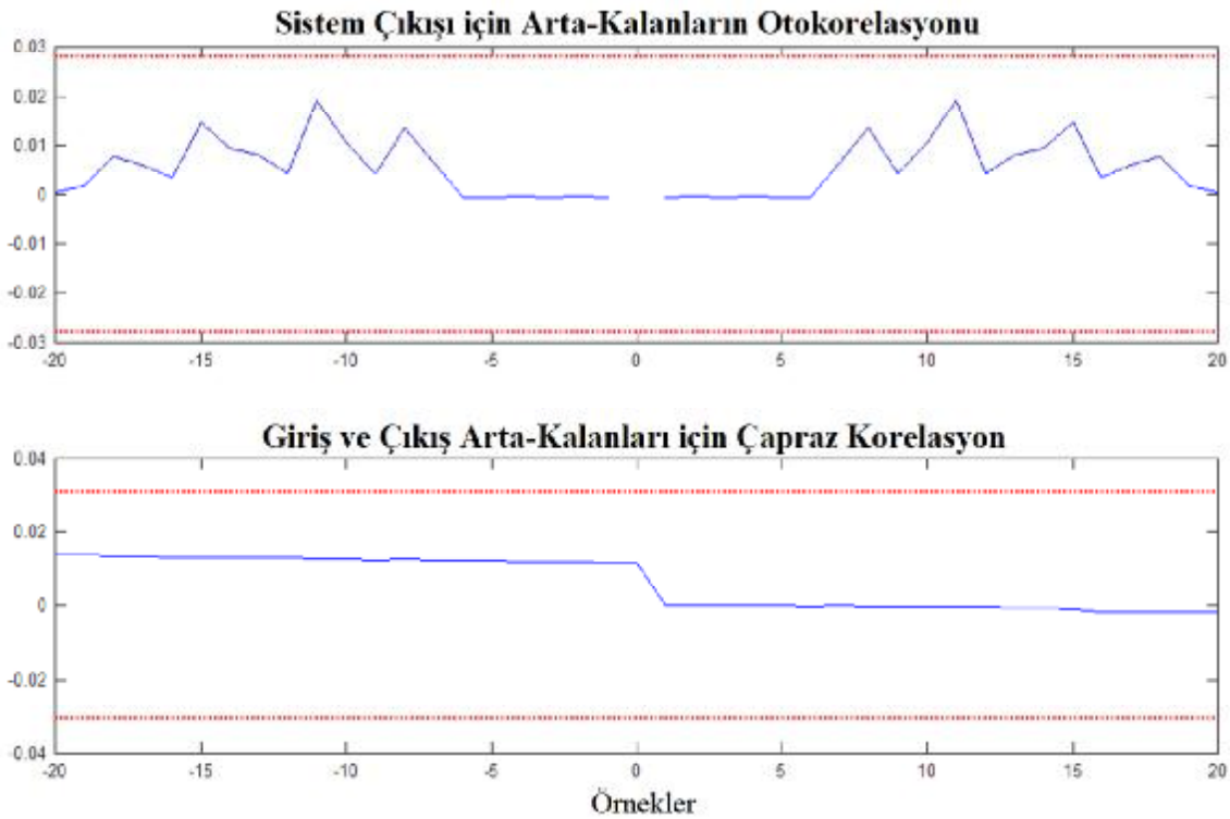
Şekil 4.20 RRR eklem yapısına sahip yalpa sisteminin otokorelasyon ve çapraz korelasyon analizi.
