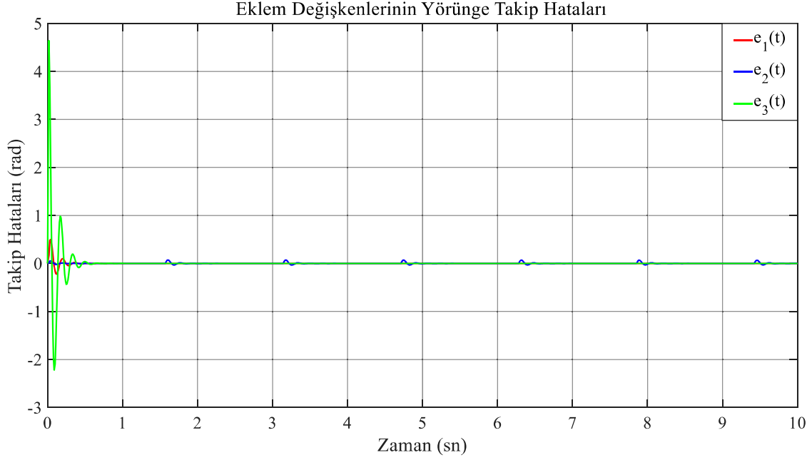
Şekil 5.9 PID denetimli RRR eklem yapısına sahip yalpanın eklem değişkenlerinin e_1(t) , e_2(t) ve e_3(t) yörünge takip hataları ( \omega_n = 10 ).
