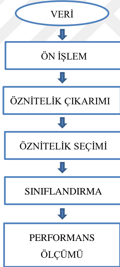
Şekil 4.1 Genel bir örüntü tanıma sistemi akış şeması.
