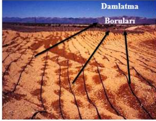
Şekil 5.6 Damlatma sistemi ile siyanür çözeltilisinin yığın üzerine uygulanması (URL-5 2018)
