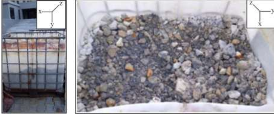
Şekil 7.2 İkincil çeneli çıkışı malzemenin görünümü (yaklaşık 2 ton).
