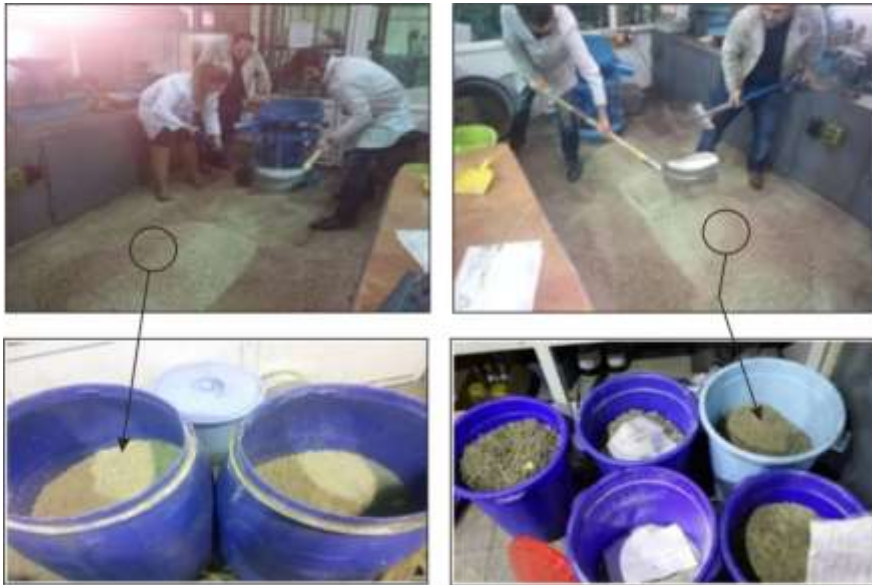
Şekil 7.1 Üçüncül çeneli çıkışı malzemelerin konileme - dörtleme metodu ile azaltılarak kovalara doldurulması (yaklaşık 1,5 ton).
