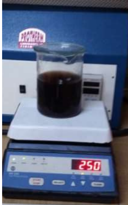
Şekil 7.27 Manyetik karıştırıcıda fındık kabuğunun 1 gr/lt NaCN içeren çözeltili ile muamele edilmesi.
