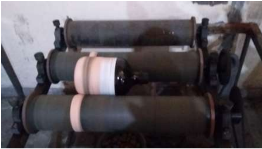
Şekil 7.15 “Bottle - Roll” (Şişe Testi) deney düzeneği.
