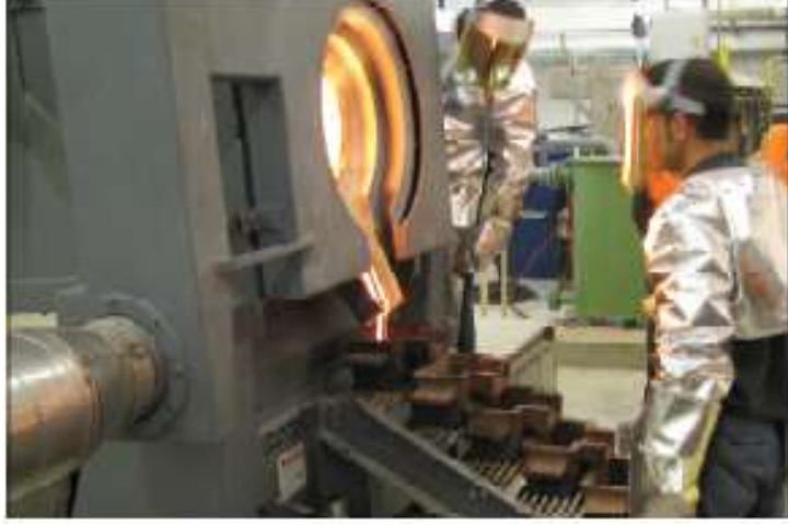
Şekil 3.7 Katotda toplanan altının ergitme fırınında ergitilmesi (AMD 2011).
