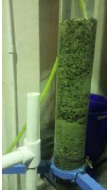
Şekil 7.14 %5 oranında -10 mm boyutlu fındık kabuğu ile -2,36 mm boyutlu numune karışımının “Geçirgenlik Deney Seti” görünümü.
