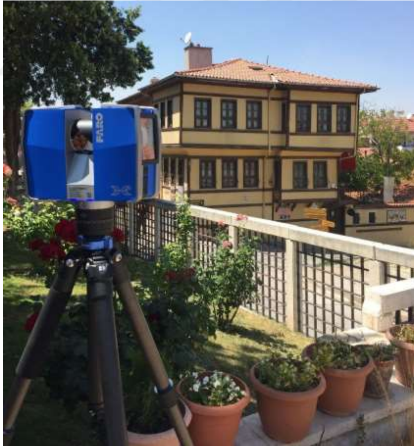
Şekil 2.4 Yersel lazer tarayıcı sistem örneđi (URL 3)
