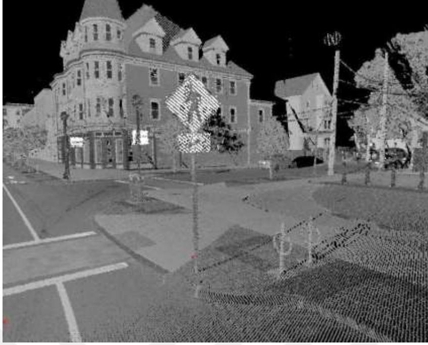
Şekil 3.6 Faro X-330 ile bina modellemesi için oluşturulmuş nokta bulutu (Derek 2016)
