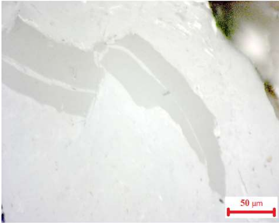
Şekil 4.29.c Mikro faylanma (Mikro düzeyde kırıklanma sonucu sporinir kırılmış ve oluşan baskı üzerine birbiri üzerine binmiştir)
