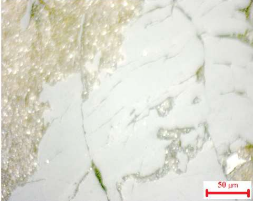
Şekil 4.29.a Mineral madde ve vitrinit(tane hem organik hemde inorganik kısımlardan oluşuyor, serbest haldeki bu tane atığa giderse atık külünü düşürür, temiz kömüre giderse kül içeriğini yükseltir
