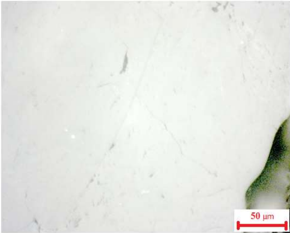
Şekil 4.28.c Vitrinit (telakollinit, rank vitrinite olarak bilinir ve yansıtma değerleri bu maseraller üzerinde yapılır)
