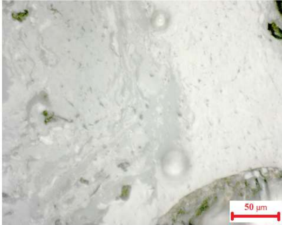
Şekil 4.29.g Semifusinit (yüksek ve düşük yansıtımlı semifüzünitler, parlak olan nispeten daha düşük reaktivite gösterir)
