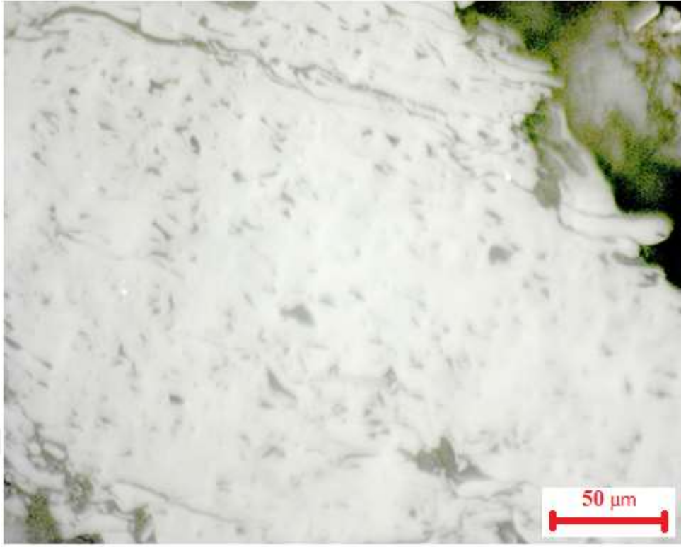
Şekil 4.27.a Semifüzinite (yüksek yansıtımalı, sıkışma nedeniyle boşluklar önemli düzeyde kapanmış)
