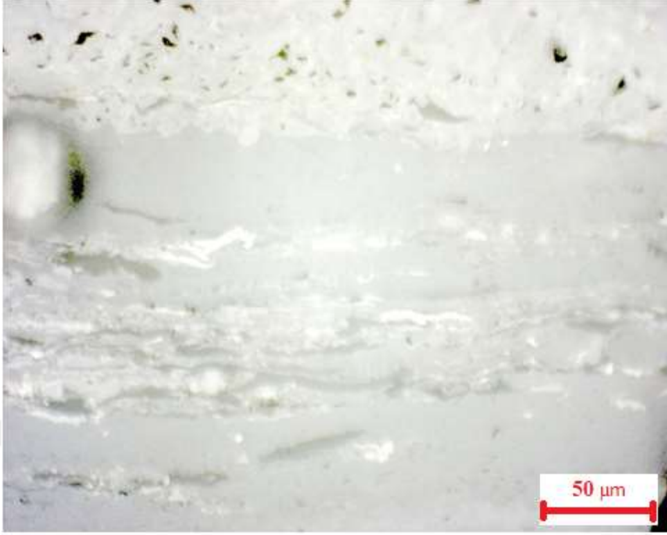
Şekil 4.29.h Semifünitten vitrinite geçiş (vitrinitik hamur içerisinde sporinitler ve detritik inertiniler)
