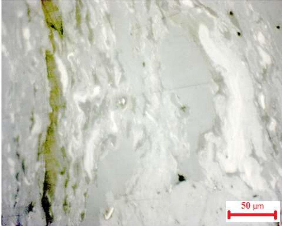
Şekil 4.26.c İntertinit, semifusinit, inertinit ve liptinit(farklı yansıtma özelliğine sahip semifuzinit bantları ve detrinitik formda inertinitler, liptinit-sporinit maseralı)
