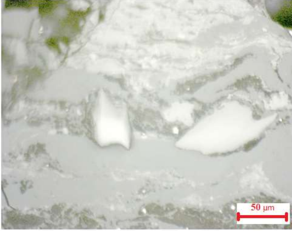
Şekil 4.27.e İntertinit/semi füzinit/mineral madde (semifüzinitik yapı içerisinde detrititik inertinitler ve mineral madde dolgusu)
