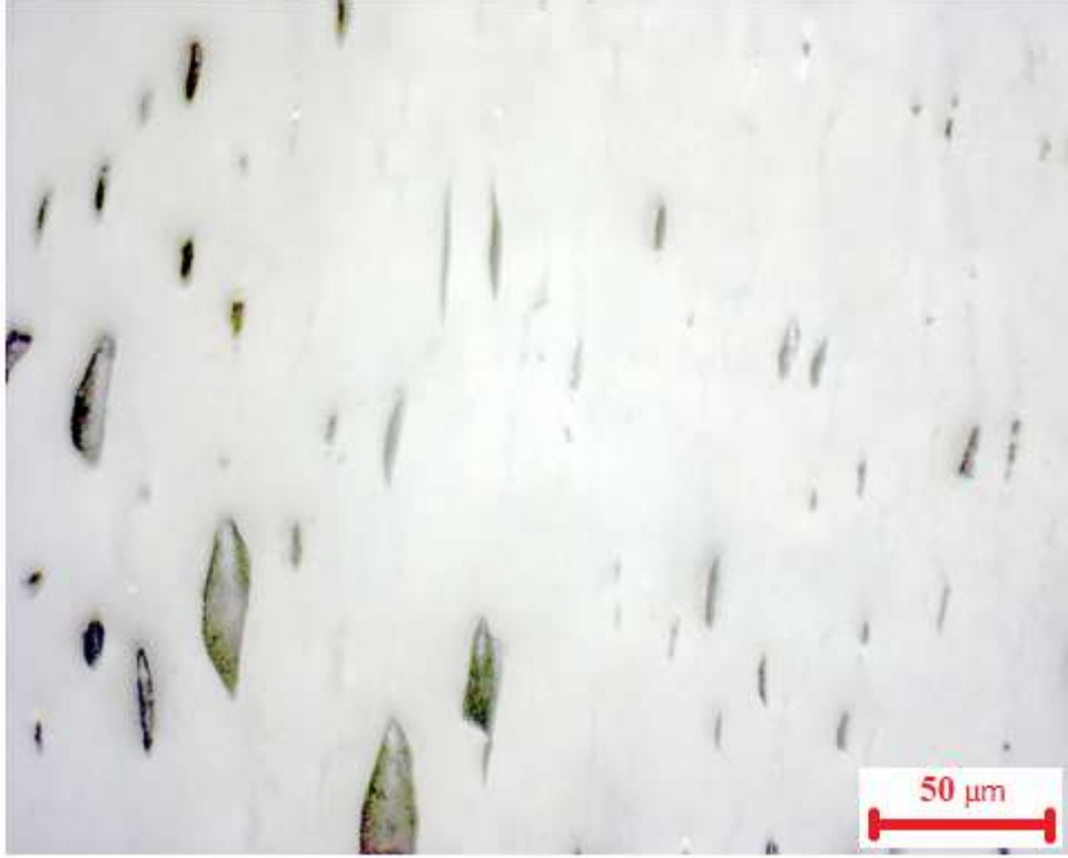
Şekil 4.28.b Semifusinit (yüksek yansıtma ve boşluklu yapı vitrinitte ve psödovitritinden ayrılmayı gösteriyor)
