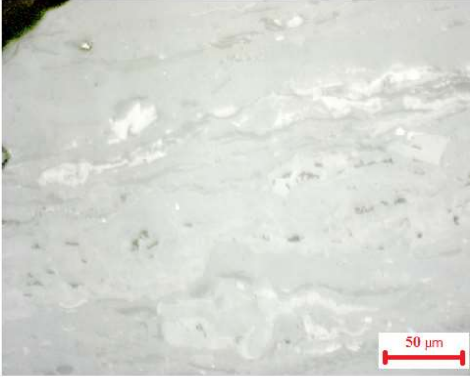
Şekil 4.28.f Vitrinitten semifüzinite geçiş, ayrıca detritil inertinitler dağılımı şekilde
