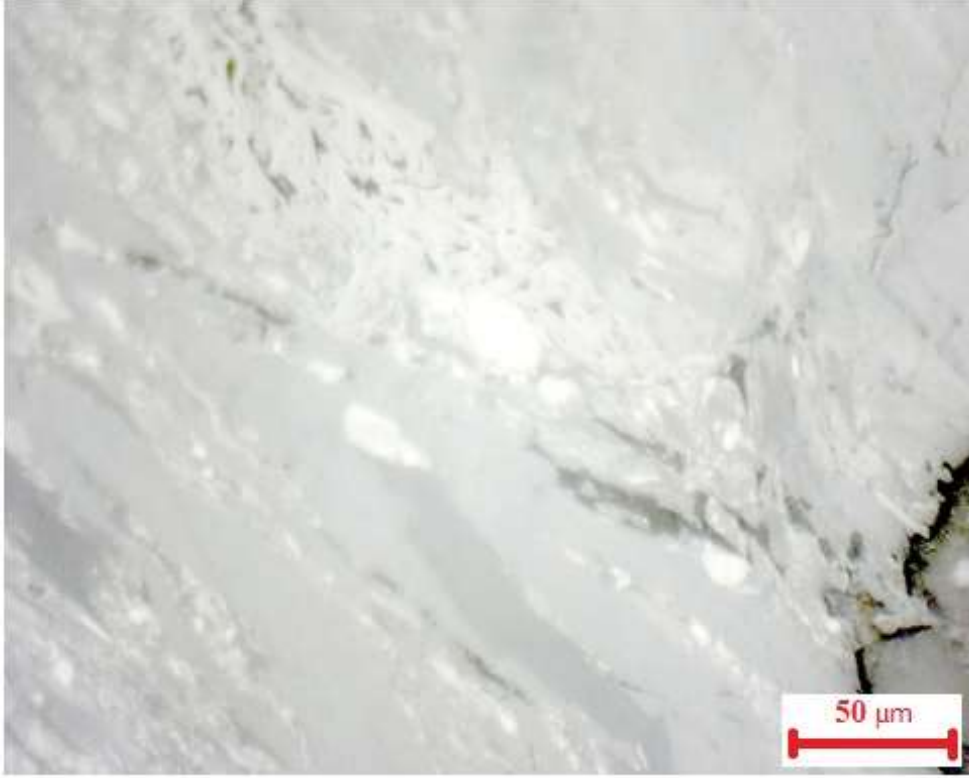
Şekil 4.28.j Vitrinit ve çeşitli formlarda (reaktif ve inert) semifüzinit
