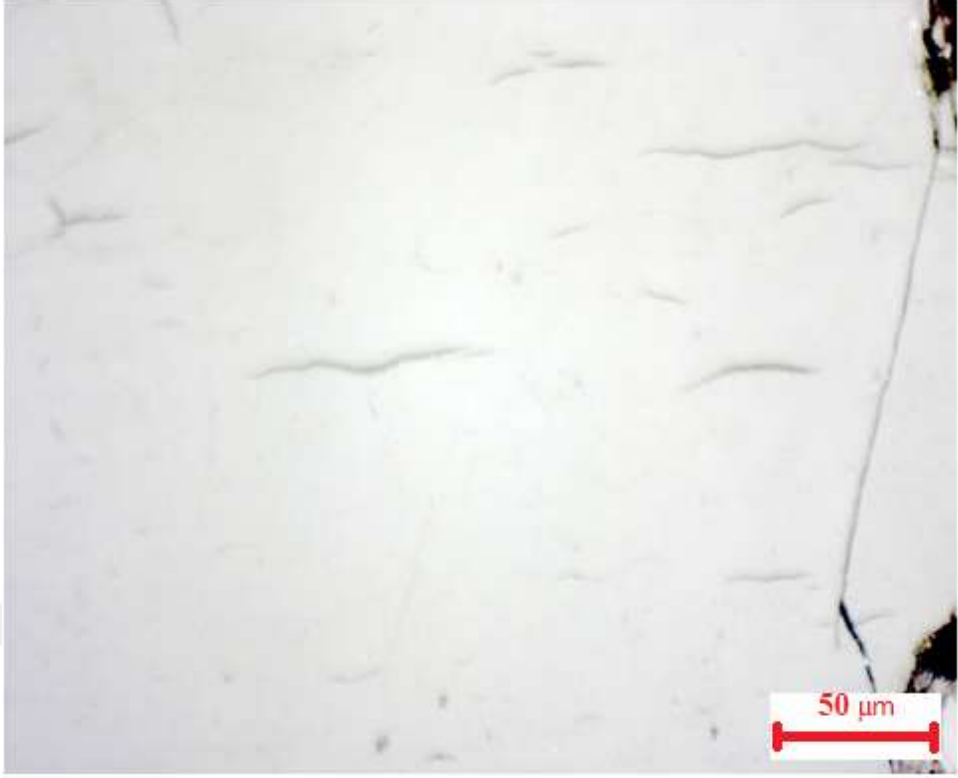
Şekil 4.27.g Psödovitrit (dalgalı boşlukları içeren yapı vitrinitten ayrılmasını gösteriyor)
