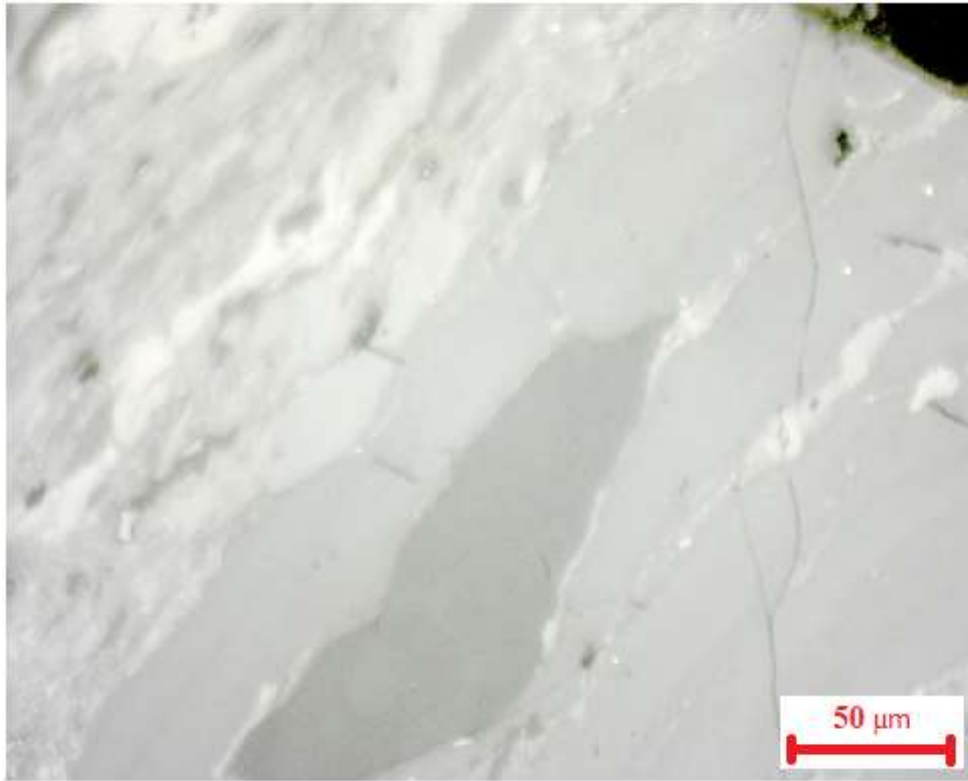
Şekil 4.27.1 Vitrinit/liptinit/inertinit/semifüzinit (semi füzinittenvitrinite geçiş, her iki yapı içerisinde gömülü liptinit-resinit ve detrinitik inertinitler).
