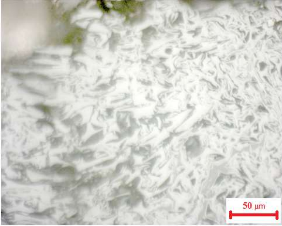
Şekil 4.26.a Fuzinit (Sıkışmış bogen yapısı, sıkışma sonucu bogen yapı kırılanmıştır)
