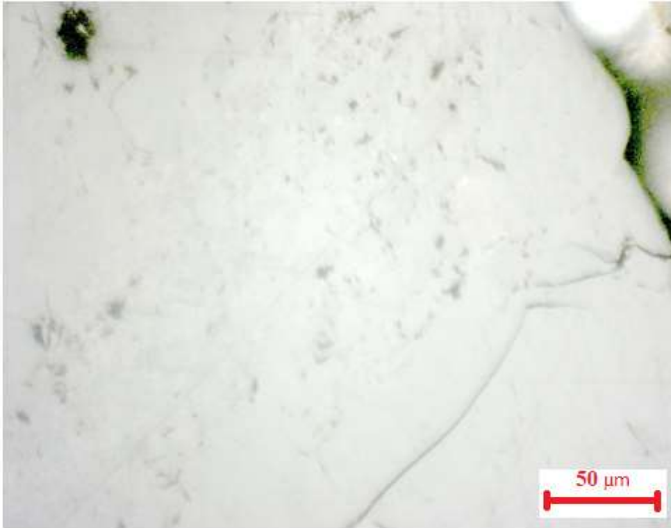
Şekil 4.26.g Vitrinit ve Semifüzinit (üst kesimde boşluklu yapı gösteren semifüzinitten vitrinite geçiş, her iki maseral de aynı yansıtma derecesine sahip)
