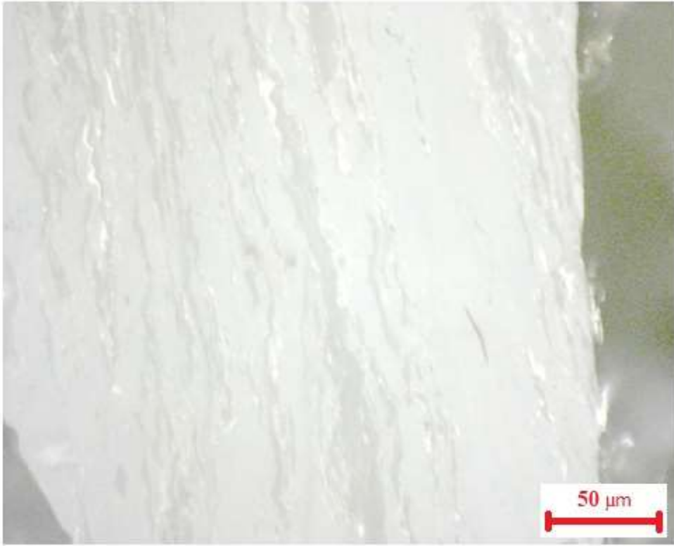
Şekil 4.28.k Vitrinit hamuru içerisinde sporinit ve inertinit
