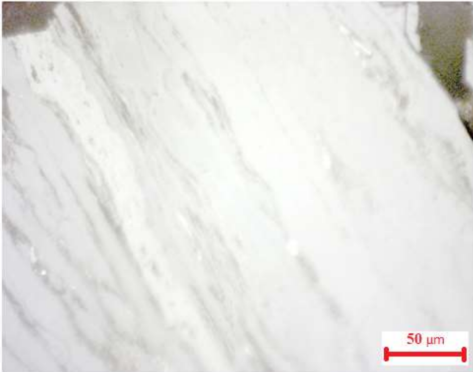
Şekil 4.27.h Vitrinit ve semifüzinite içerisinde kil bantları
