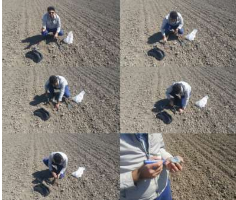
Şekil 5.8 Toprak nemi örneği toplanması.
