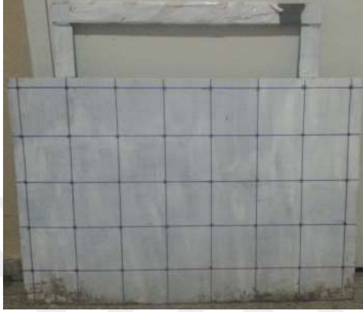
Şekil 5.5 Toprak pürüzlülük ölçümü için hazırlanan profil metre.
