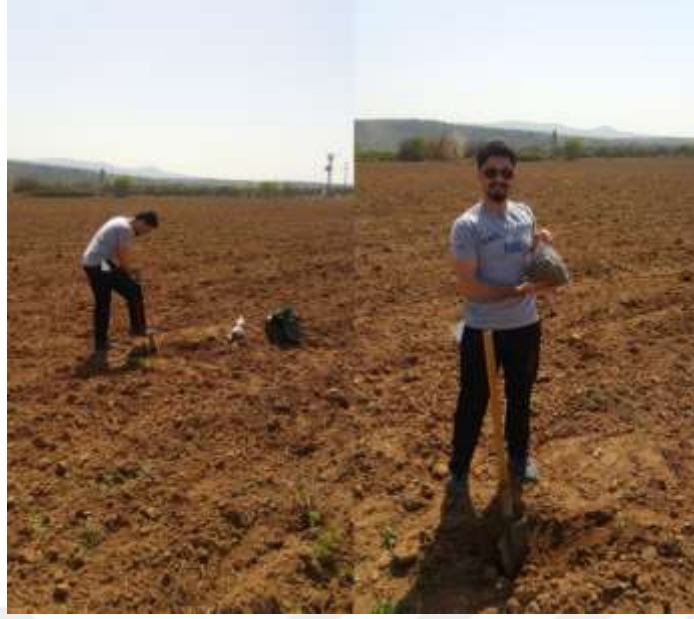
Şekil 5.7 Çalışma alanından 30 cm derinlikte toprak örneği toplanması.
