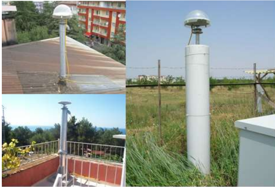
Şekil 3.3 TUSAGA-Aktif istasyon pilye tipleri (çatı, teras ve yer tipi pilye)
