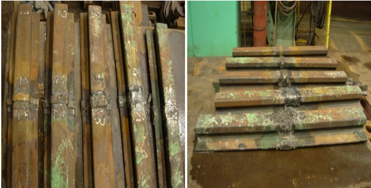
Şekil 3.5 Termit Kaynaklı Numuneler a) Üstten Görünüş ve b) Alından Görünüş.
