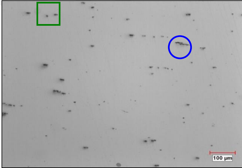
Şekil 3.3 A100 Rayının İnkluzyon Durumu (Optik Mikroskop x100).
