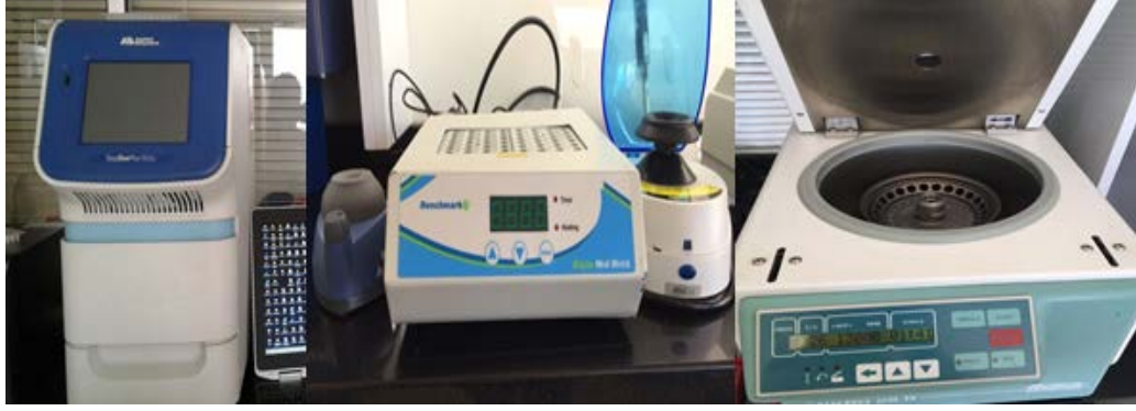
Şekil 9: DNA Ekstraksiyonu Sırasında Kullanılan Santrifüj Cihazı, İnkübasyon Cihazı ve Gerçek Zamanlı PCR Cihazı
