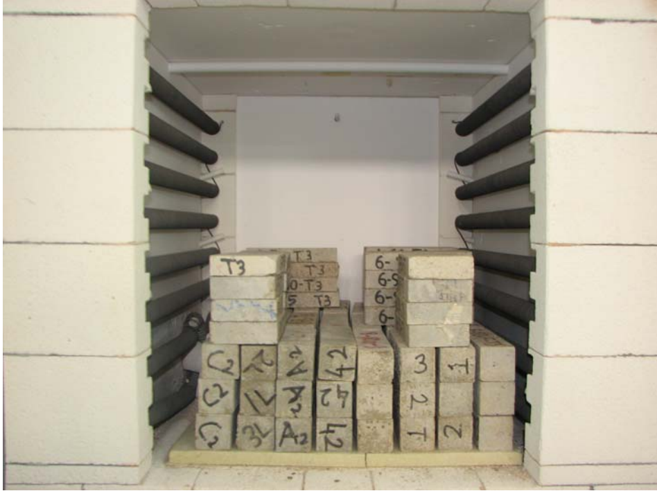
Şekil 3.8. Numunelerin Fırına Konulması
