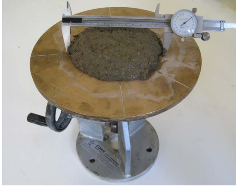
Şekil 3.11. Yayılma Deneyi Düzeneği
