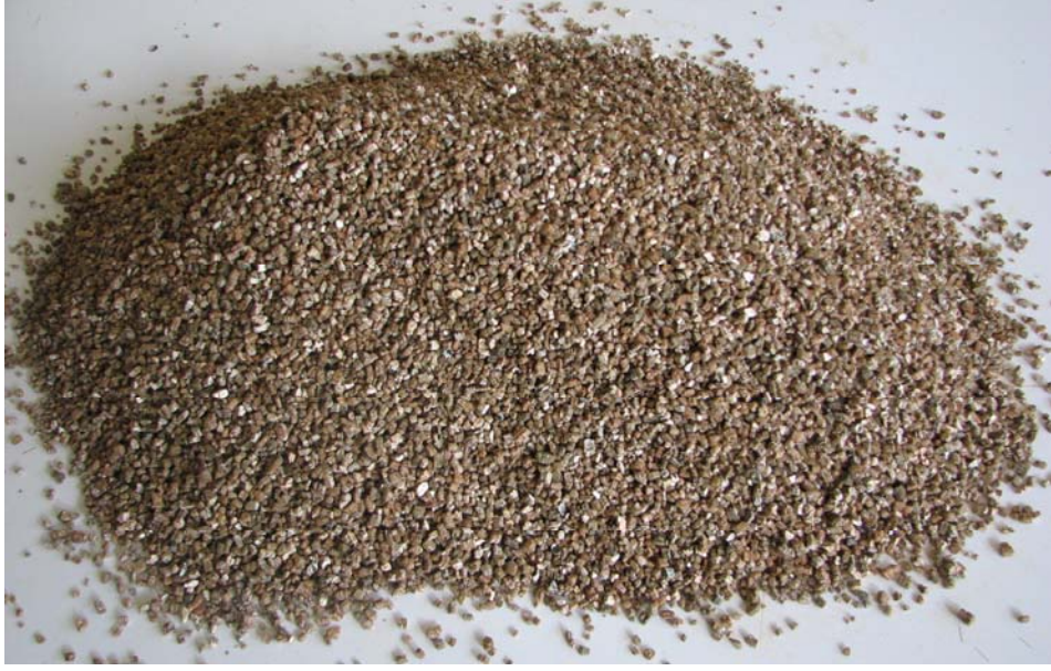
Şekil 3.2. Çalışmada Kullanılan Genleştirilmiş Vermikülit
