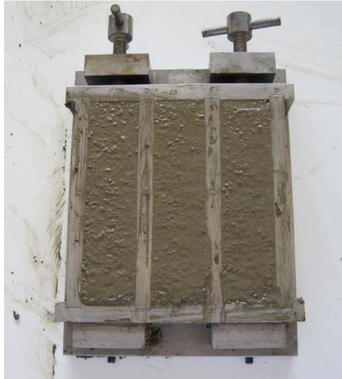
Şekil 3.7. Numunenin Kalıba Yerleştirilmiş Hali
