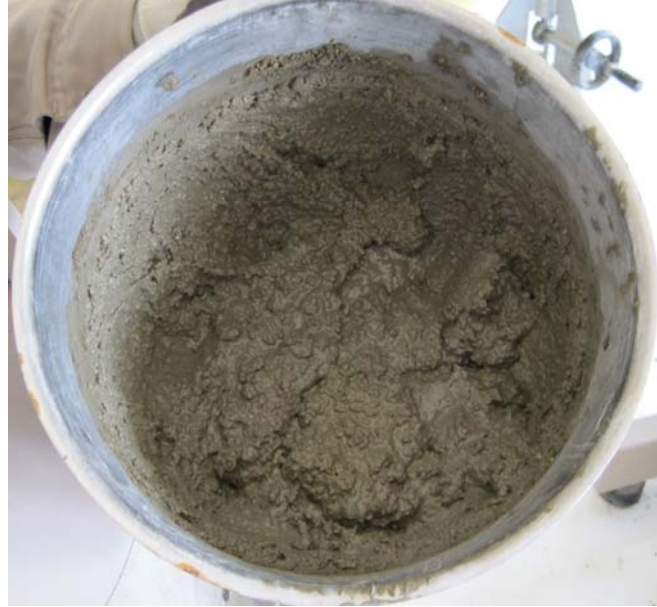
Şekil 3.5. Genleştirilmiş Vermikülit Kullanılarak Üretilen Harç
