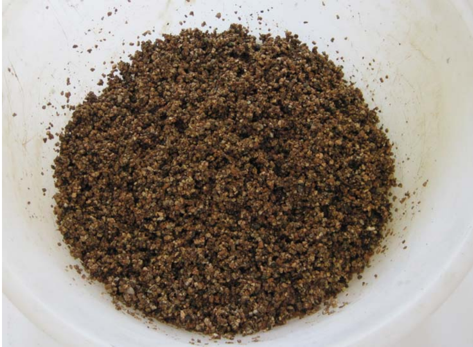
Şekil 3.3. Genleştirilmiş Vermikülitte Su Verilmesi
