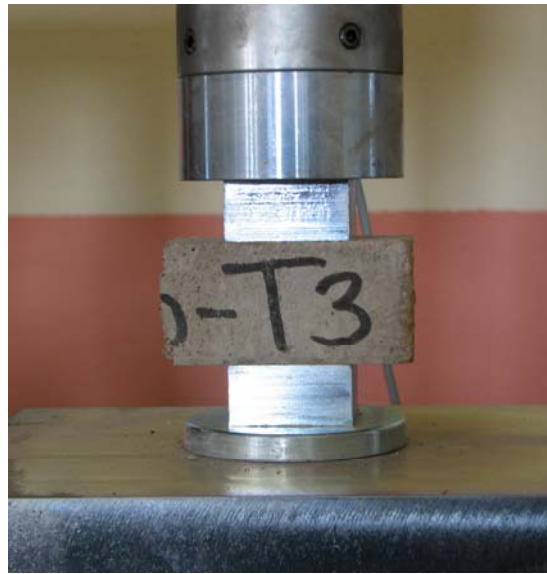
Şekil 3.15. Basınç Dayanımı Deney Düzeneği
