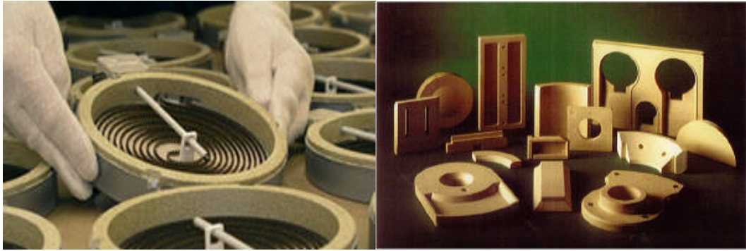
Şekil 2.12. Vermikülitin Üretimde İzolasyon Malzemesi Uygulaması [37]
