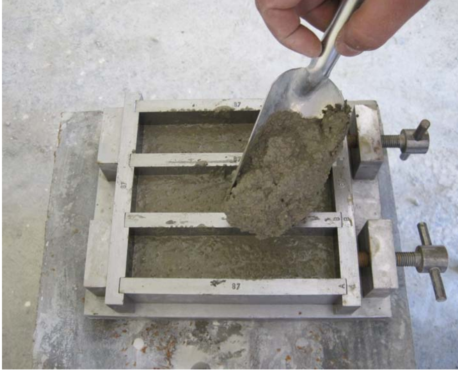
Şekil 3.6. Numunenin Kalıba Yerleştirilmesi
