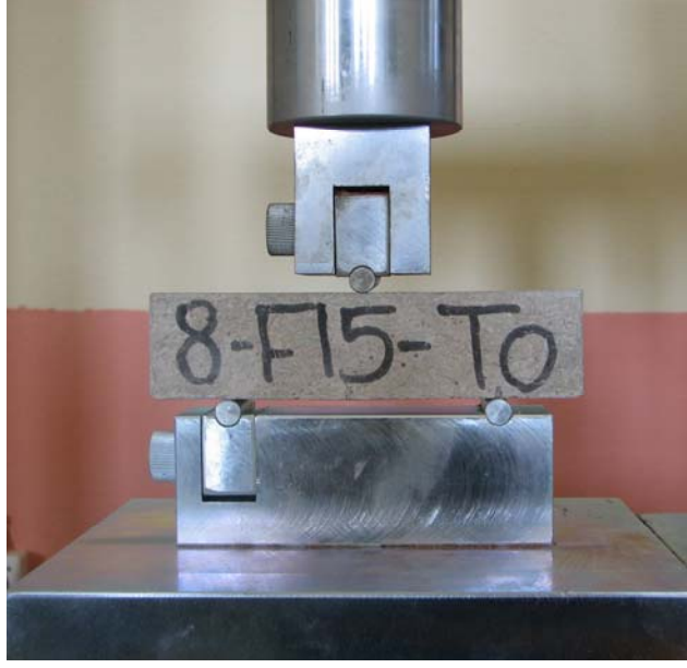
Şekil 3.13. Eğilme Dayanımı Deney Düzeneği
