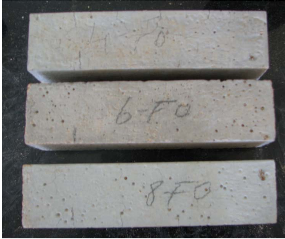
Şekil 3.10. 900°C Sıcaklık Sonrası Çelik Tel İçermeyen Numuneler
