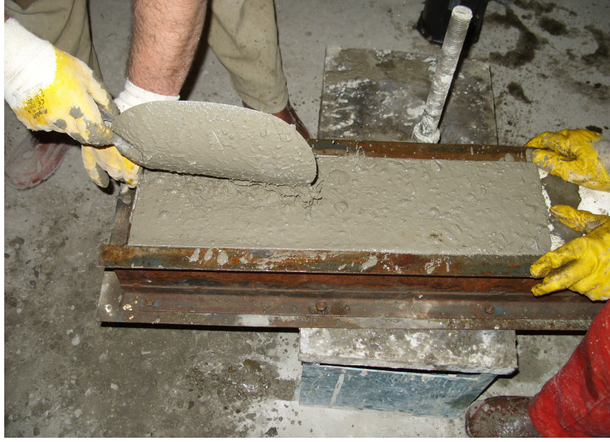
Şekil 3.2. Kiriş beton numunesi vibratöre maruz durumda
