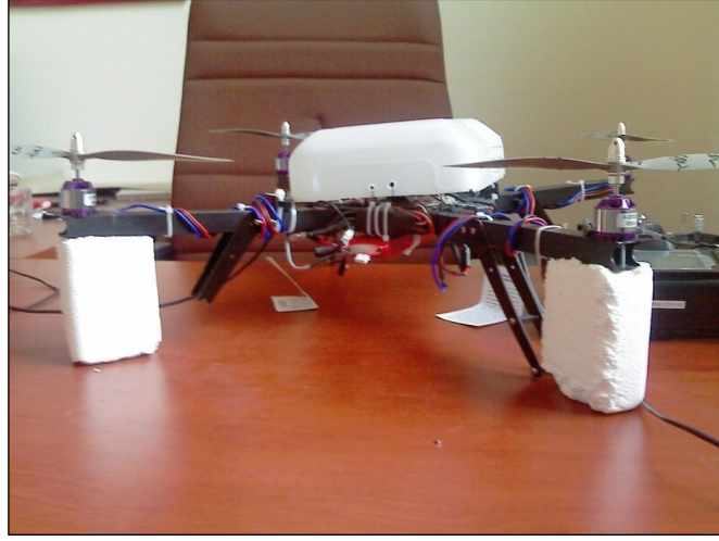
Şekil 6.3. Koruma Kapağı ve Darbe Emici Ayak Malzemeleri
