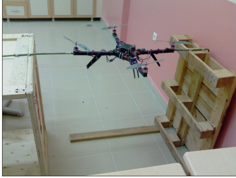
Şekil 6.2. Eksen Ayarları İçin Oluşturulan Test Düzeneği
