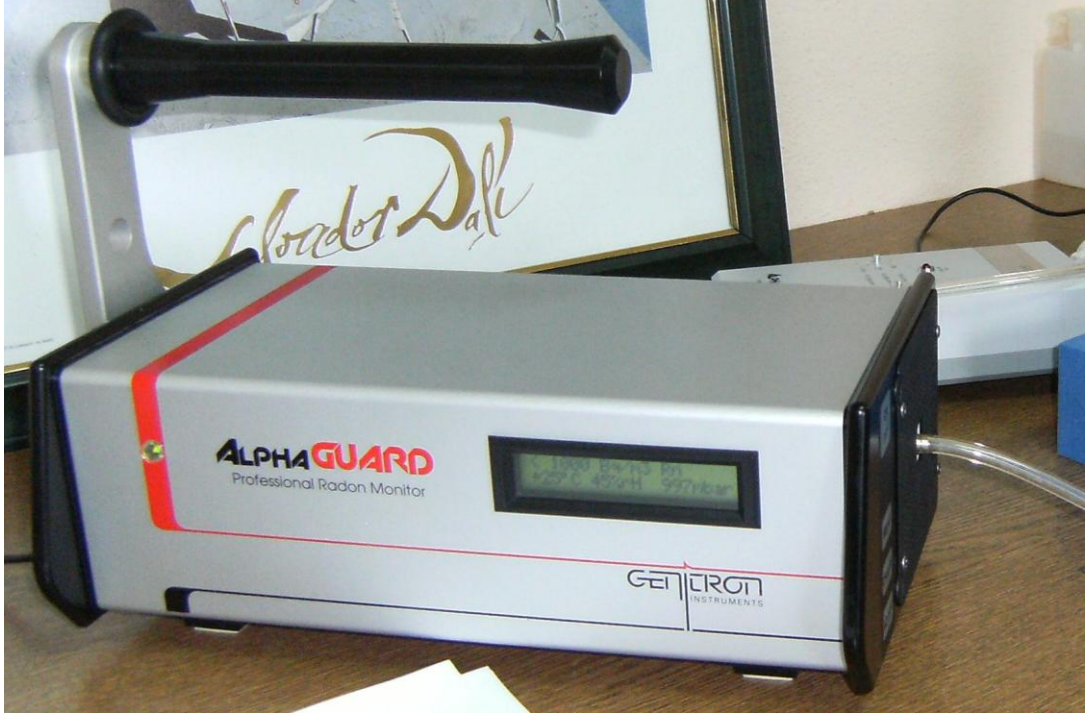
Şekil 3.2 AlphaGUARD PQ2000PRO Radon dedektörü
