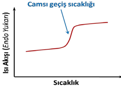
Şekil 3.2. Isı Akışı-Sıcaklık Grafiğinde Camsı Geçiş Sıcaklığının Tayininin Şematik Gösterimi [47]
