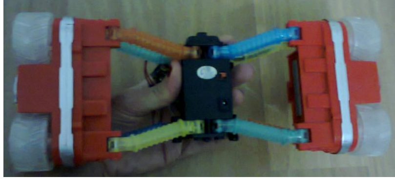
Şekil 4.17. Diferansiyel Sürüş Mekanizması Alt Görünüm
