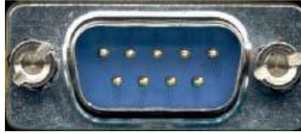
Şekil 4.12. RS232 DB-9P Konektörün Fiziksel Görünüşü
